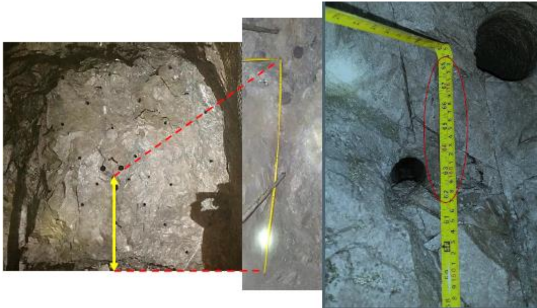
Figura N° 78: Altura del arranque de la malla modificada a 1.00 m del piso (PRUEBA N°2, 3, 4 y 5)
