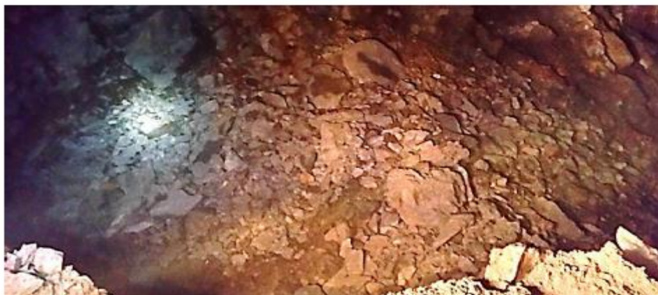
Figura N° 72: Resultado del disparo en el tajo 684
