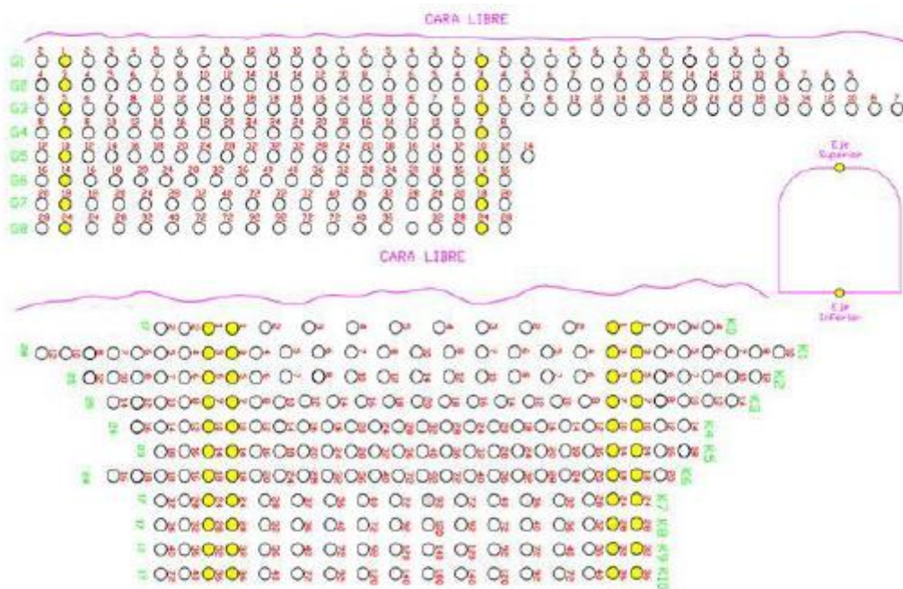
Figura N° 74: Distribución de retardos para mallas G y K.
