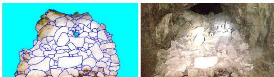
Figura N° 95: Fragmentación Ventana N°2 Tajo 640
