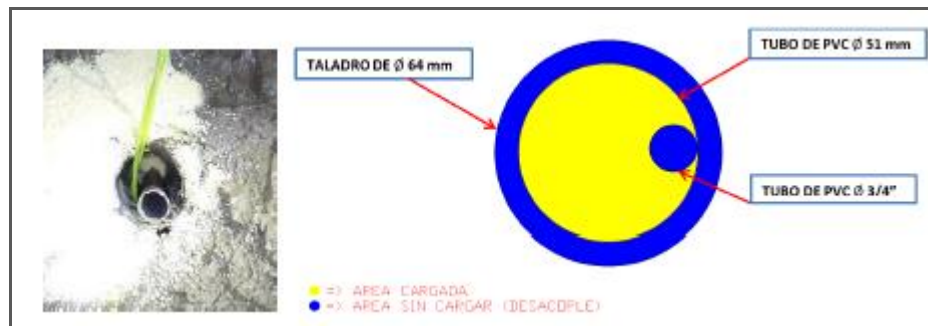
Figura N° 17: Desacoplamiento del taladro con tubo de PVC de 3/4"
