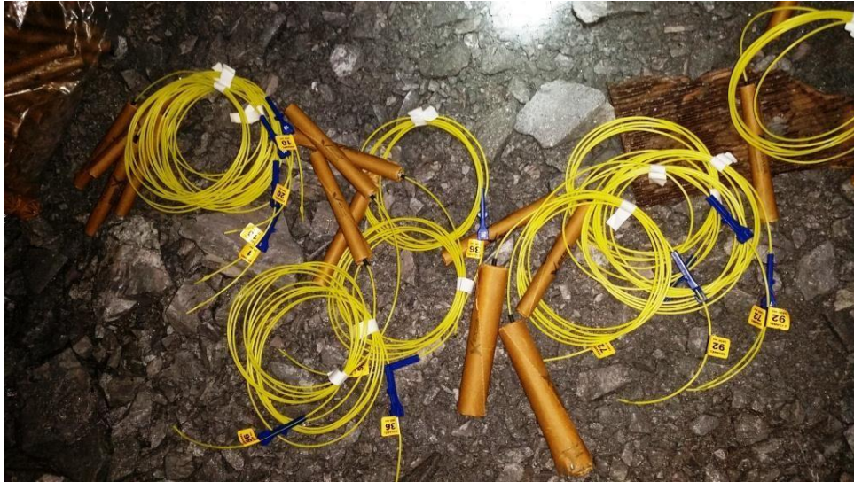
Figura N° 86: Uso de cartucho Semexa E para cebo de diferente diámetro
