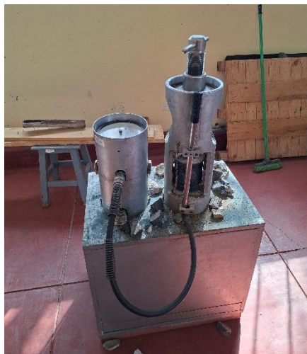
Figura44. Anexo 8 Vista general del equipo portátil para ensayo de carga puntual (PLT).
