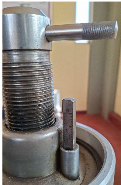
Figura46. Anexo 10 Medición de la distancia entre puntas (diámetro equivalente).
