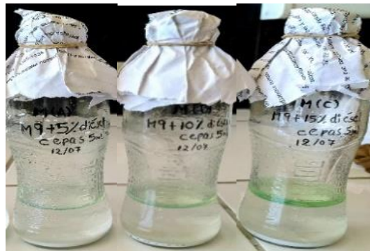
Medio mínimo M9 con petróleo diésel al 5, 10 y 15 % para la adaptación y tolerancia.
