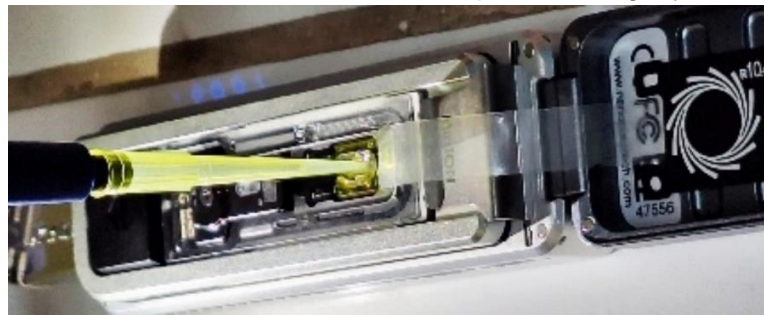
Primado y cargado de la celda de flujo Flongle
