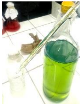
Medio mínimo M9 con petróleo diésel al 5, 10 y 15 % para la adaptación y tolerancia.
