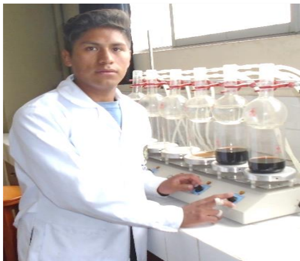
Foto 5. Determinación de contenido de fibra bruta en la cocina eléctrica.
