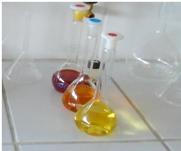
Foto 10. Diluciones necesarias para la lectura de absorbancia en el espectrofotómetro.
