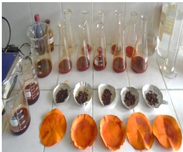
Foto 9. Ensayos preliminares de extracción de colorante de achiote refino y extracto.
