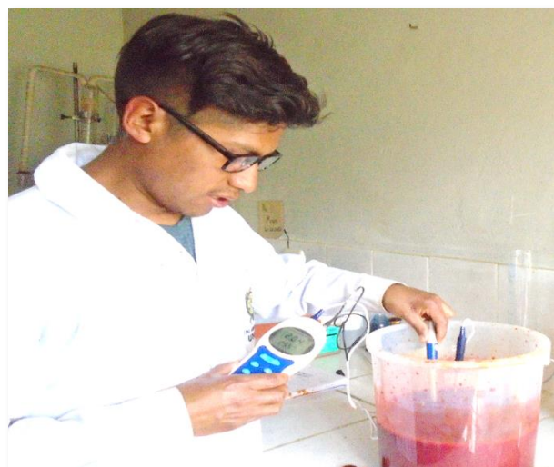
Foto 7. Mediante la adición de solución de ácido sulfúrico \text{H}_2\text{SO}_4 10 % regular el PH de la solución hasta llegar a 2.06.
