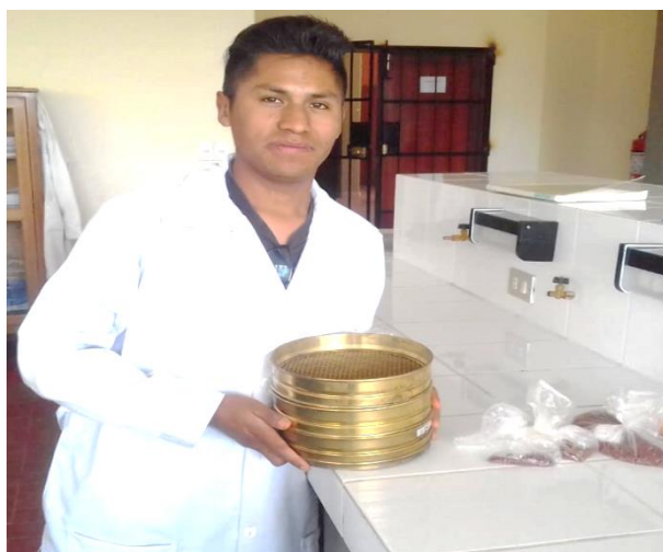
Foto 4. Tamizado de materia prima (semilla de achiote) para obtener coeficiente
