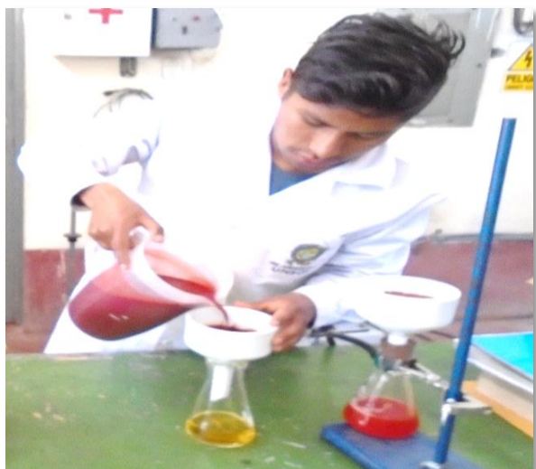
Foto 8. Se realiza filtración de bomba al vacío para obtener norbixina pura en polvo
