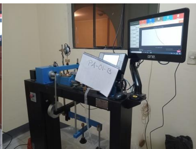
FOTOGRAFIAS 13 y 14 ANEXO. Se evidencia el ensayo de Corte Directo una de las muestras "Creación y mejoramiento de los servicios de agua potable y saneamiento básico en 9 comunidades del centro poblado de puerto mayo y quisto central".
