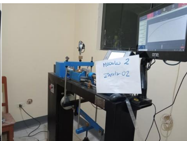
FOTOGRAFIAS 19 y 20 ANEXO. Se evidencia el ensayo de Corte Directo una de las muestras “Mejoramiento de los Servicios de Formación Profesional en Ingeniería Agroindustrial de la Universidad Nacional de San Cristóbal de Huamanga, distrito de Ayacucho”.
