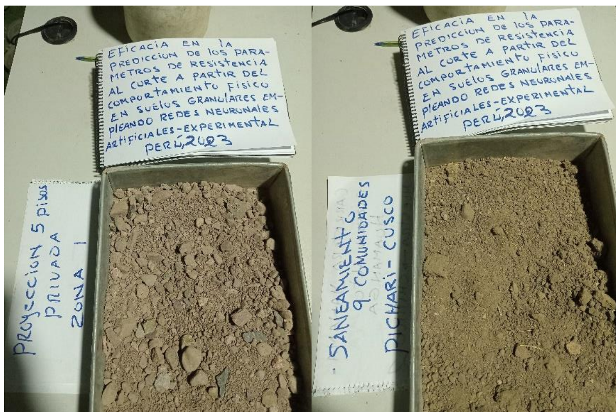
FOTOGRAFIAS 49 y 50 ANEXO. Se evidencia las muestras de los suelos recolectados para ensayos de clasificacion y corte directo.
