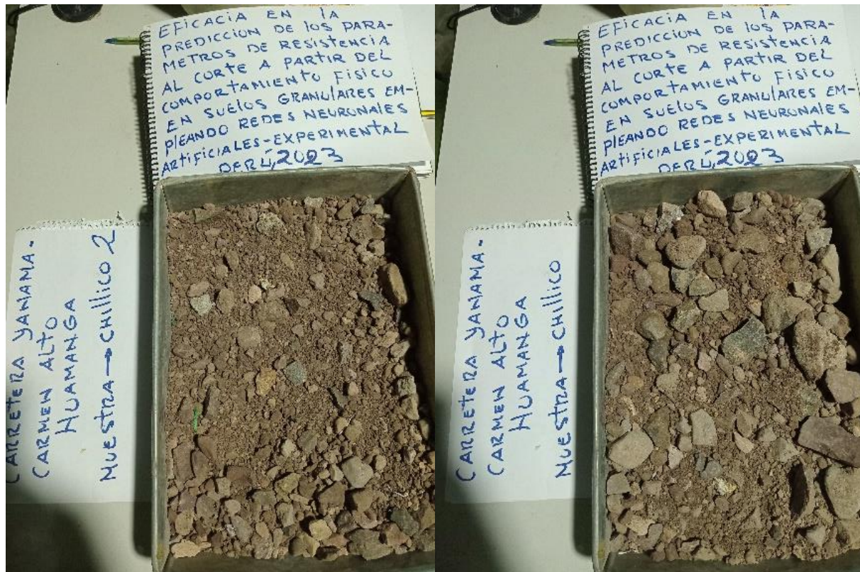
FOTOGRAFÍAS 45 y 46 ANEXO. Se evidencia las muestras de los suelos recolectados para ensayos de clasificación y corte directo.
