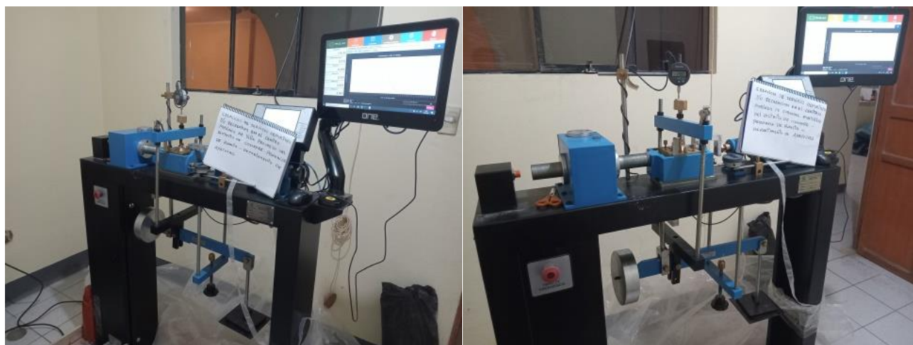
FOTOGRAFIAS 07 y 08 ANEXO. Se evidencia el ensayo de Corte Directo una de las muestras Construcción de cobertura de la institucion deportiva en la I.E.S San Luis Gonzaga en la localidad de Conayre.
