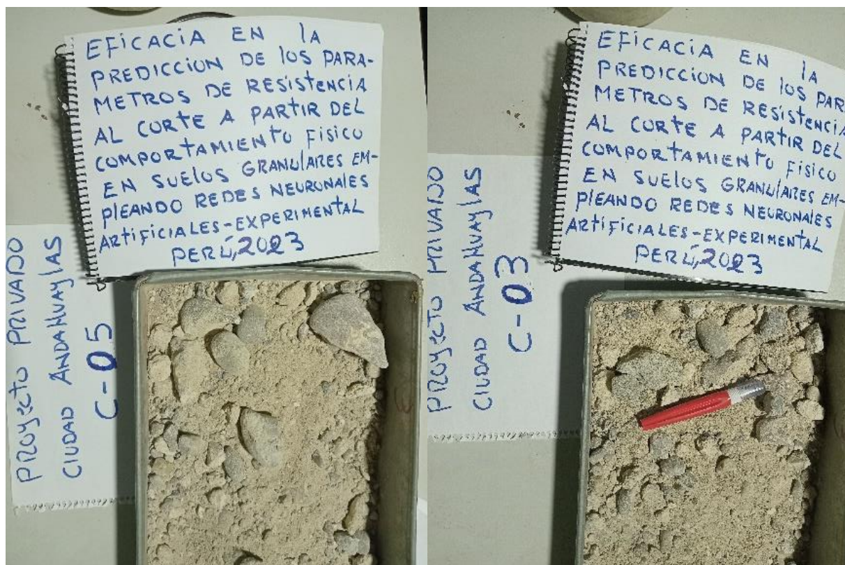
FOTOGRAFIAS 55 y 56 ANEXO. Se evidencia las muestras de los suelos recolectados para ensayos de clasificacion y corte directo.
