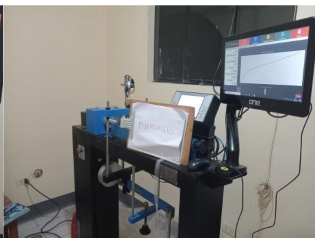
FOTOGRAFIAS 13 y 14 ANEXO. Se evidencia el ensayo de Corte Directo una de las muestras "Creación y mejoramiento de los servicios de agua potable y saneamiento básico en 9 comunidades del centro poblado de puerto mayo y quisto central".
