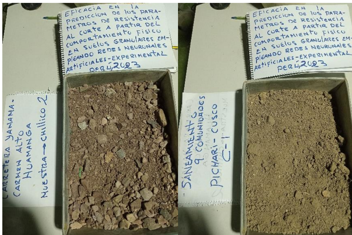
FOTOGRAFIAS 47 y 48 ANEXO. Se evidencia las muestras de los suelos recolectados para ensayos de clasificacion y corte directo.
