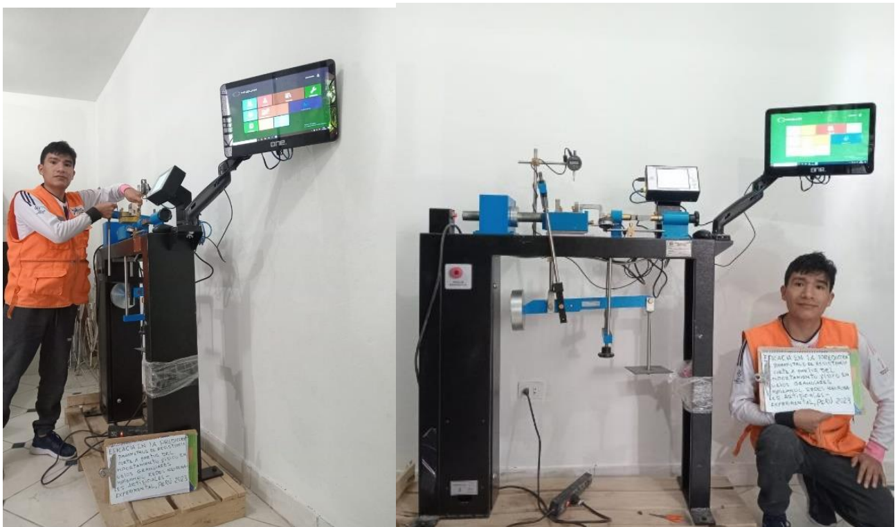
FOTOGRAFIAS 03 y 04 ANEXO. Se evidencia el manejo del equipo del corte directo por parte del tesista.
