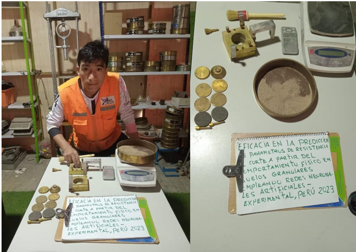
FOTOGRAFIAS 01 y 02 ANEXO. Se evidencia las partes del caja de corte directo.
