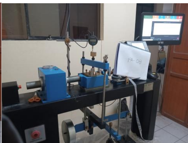
FOTOGRAFIAS 17 y 18 ANEXO. Se evidencia el ensayo de Corte Directo una de las muestras “Creación y mejoramiento de los servicios de agua potable y saneamiento básico en 9 comunidades del centro poblado de puerto mayo y quisto central”.
