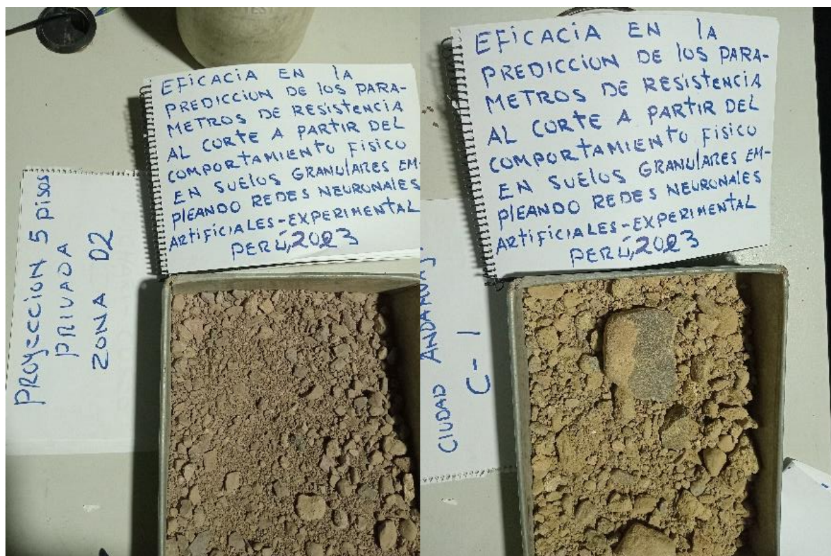
FOTOGRAFÍAS 51 y 52 ANEXO. Se evidencia las muestras de los suelos recolectados para ensayos de clasificación y corte directo.
