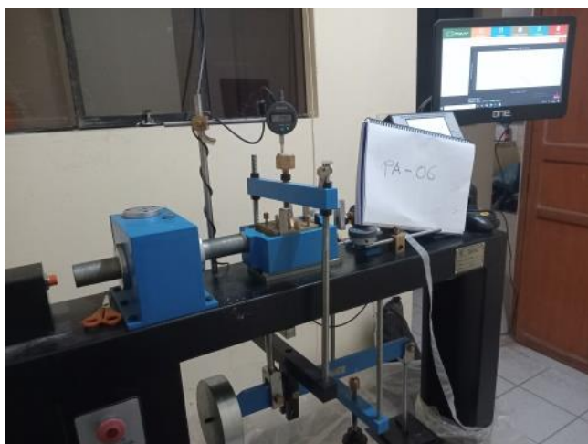
FOTOGRAFIAS 17 y 18 ANEXO. Se evidencia el ensayo de Corte Directo una de las muestras “Creación y mejoramiento de los servicios de agua potable y saneamiento básico en 9 comunidades del centro poblado de puerto mayo y quisto central”.
