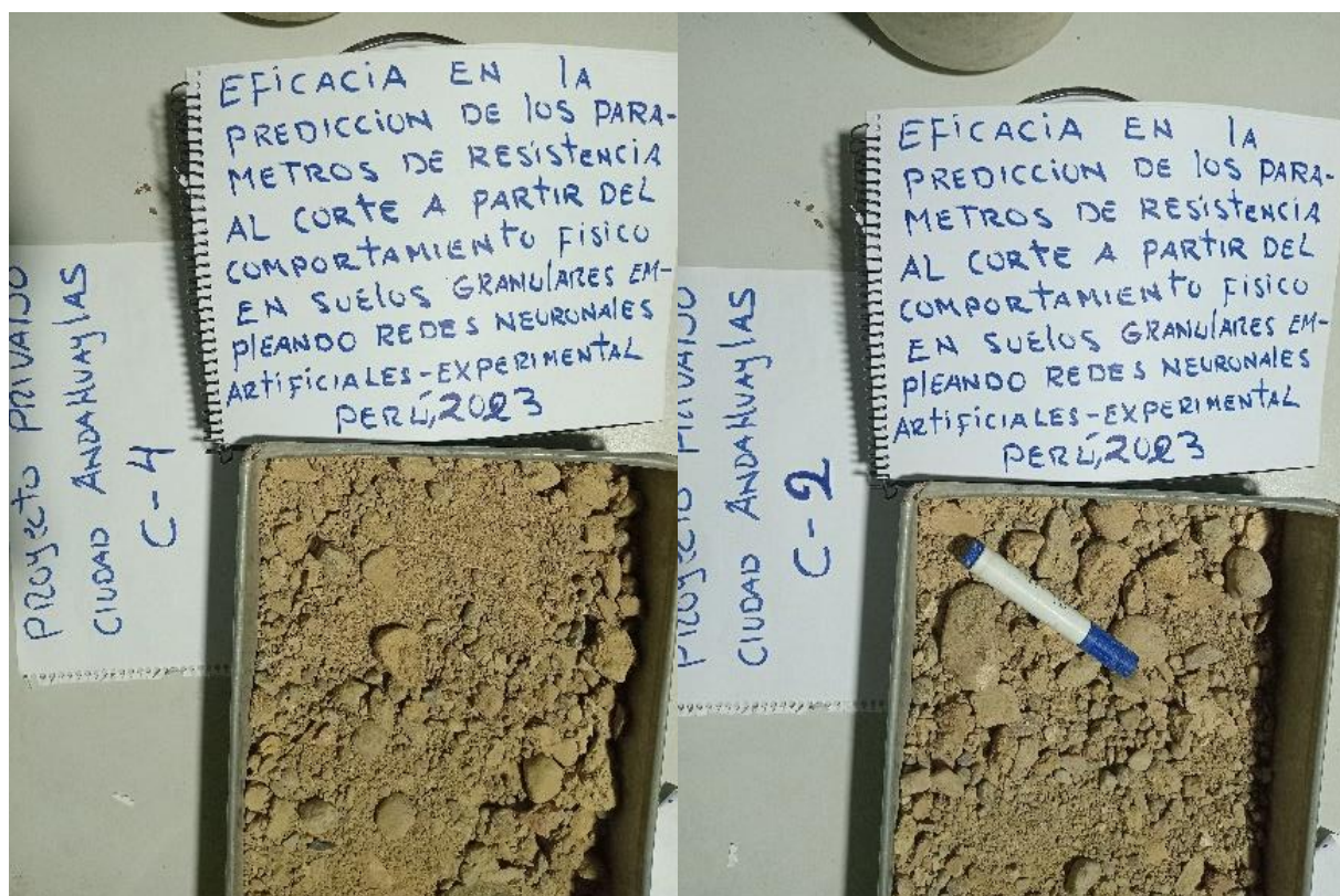
FOTOGRAFÍAS 53 y 54 ANEXO. Se evidencia las muestras de los suelos recolectados para ensayos de clasificación y corte directo.
