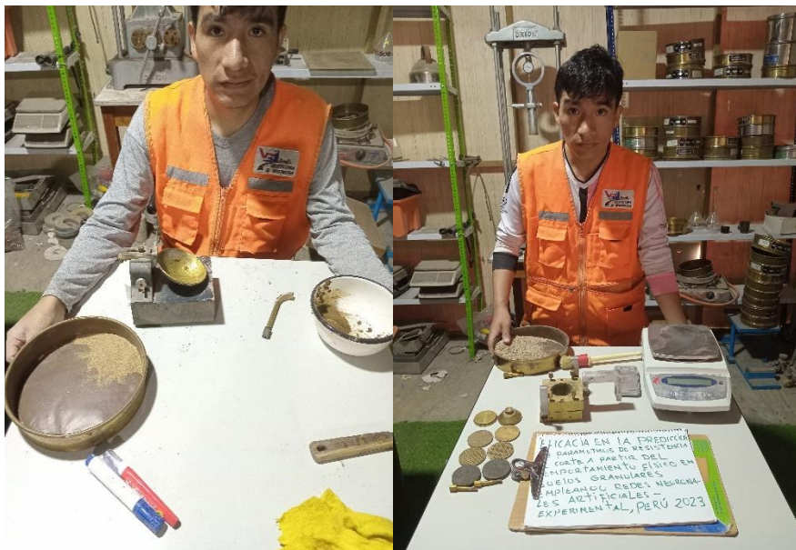
FOTOGRAFIAS 05 y 06 ANEXO. Se evidencia el ensayo de consistencia (LL) del suelo con metodo copa de Casagrande.
