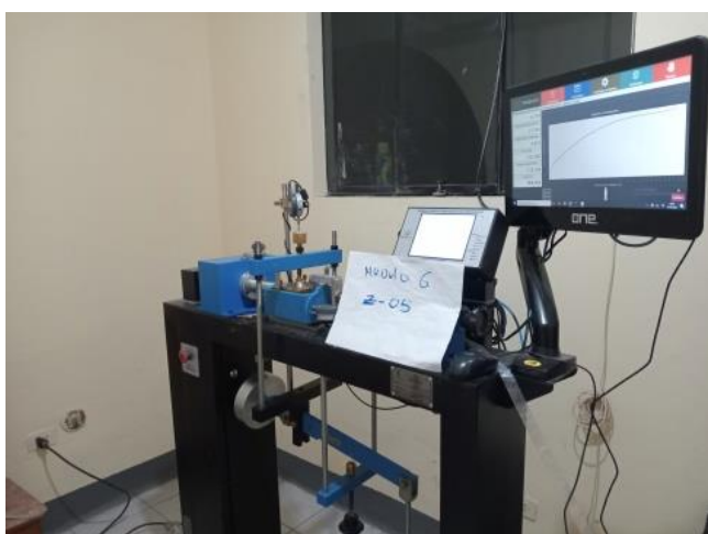
FOTOGRAFIAS 19 y 20 ANEXO. Se evidencia el ensayo de Corte Directo una de las muestras “Mejoramiento de los Servicios de Formación Profesional en Ingeniería Agroindustrial de la Universidad Nacional de San Cristóbal de Huamanga, distrito de Ayacucho”.
