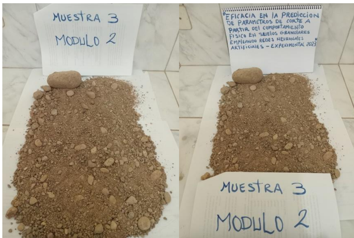
FOTOGRAFIAS 33 y 34 ANEXO. Se evidencia las muestras de los suelos recolectados para ensayos de clasificación y corte directo.
