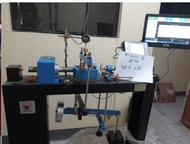
FOTOGRAFIAS 21 y 22 ANEXO. Se evidencia el ensayo de Corte Directo una de las muestras “Mejoramiento de los Servicios de Formación Profesional en Ingeniería Agroindustrial de la Universidad Nacional de San Cristóbal de Huamanga, distrito de Ayacucho”.
