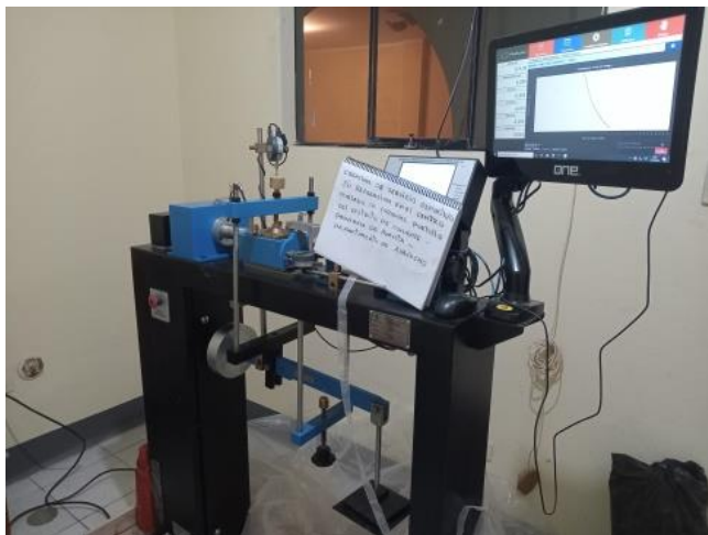
FOTOGRAFIAS 11 y 12 ANEXO. Se evidencia el ensayo de Corte Directo una de las muestras Construcción de cobertura de la institucion deportiva en la I.E.S San Luis Gonzaga en la localidad de Conayre.
