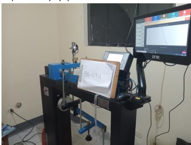
FOTOGRAFIAS 13 y 14 ANEXO. Se evidencia el ensayo de Corte Directo una de las muestras "Creación y mejoramiento de los servicios de agua potable y saneamiento básico en 9 comunidades del centro poblado de puerto mayo y quisto central".
