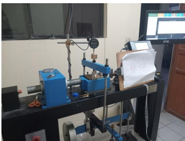
FOTOGRAFIAS 13 y 14 ANEXO. Se evidencia el ensayo de Corte Directo una de las muestras "Creación y mejoramiento de los servicios de agua potable y saneamiento básico en 9 comunidades del centro poblado de puerto mayo y quisto central".
