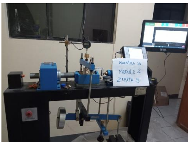
FOTOGRAFIAS 21 y 22 ANEXO. Se evidencia el ensayo de Corte Directo una de las muestras “Mejoramiento de los Servicios de Formación Profesional en Ingeniería Agroindustrial de la Universidad Nacional de San Cristóbal de Huamanga, distrito de Ayacucho”.
