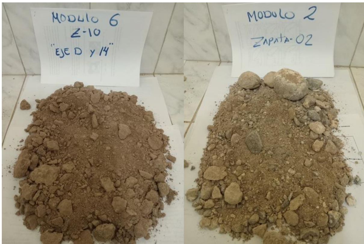
FOTOGRAFIAS 39 y 40 ANEXO. Se evidencia las muestras de los suelos recolectados para ensayos de clasificacion y corte directo.
