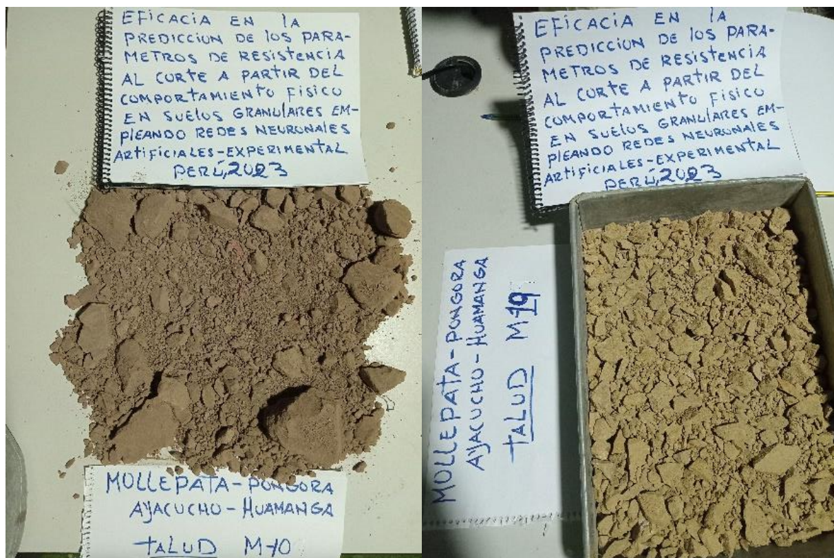
FOTOGRAFÍAS 43 y 44 ANEXO. Se evidencia las muestras de los suelos recolectados para ensayos de clasificación y corte directo.
