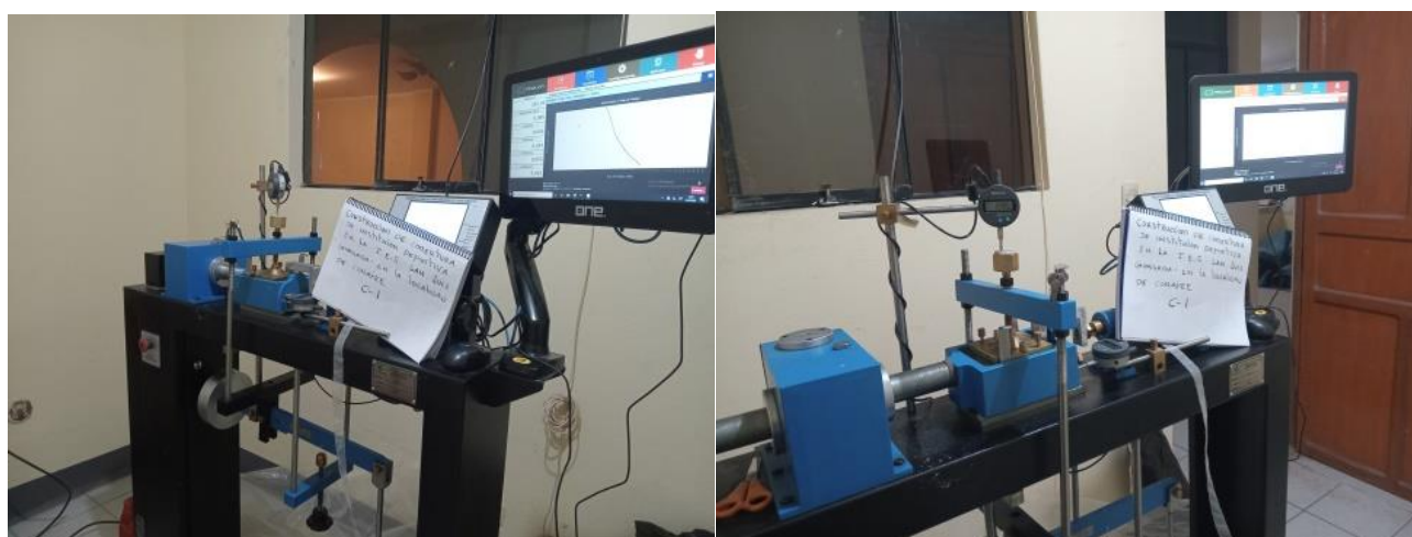
FOTOGRAFIAS 09 y 10 ANEXO. Se evidencia el ensayo de Corte Directo una de las muestras Construcción de cobertura de la institucion deportiva en la I.E.S San Luis Gonzaga en la localidad de Conayre.
