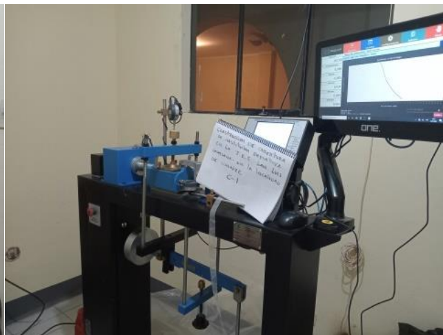
FOTOGRAFIAS 11 y 12 ANEXO. Se evidencia el ensayo de Corte Directo una de las muestras Construcción de cobertura de la institucion deportiva en la I.E.S San Luis Gonzaga en la localidad de Conayre.
