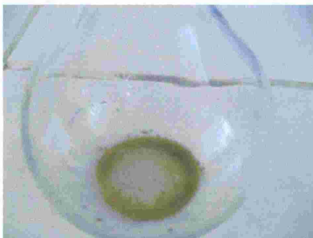
Fotografía Nº 08: Grasas y aceites extraídos a partir de aguas residuales del afluente por el método de Soxhlet, Laboratorio de análisis fisicoquímico de la Planta de Tratamiento de Aguas Residuales Totorá. Ayacucho, 2010.
