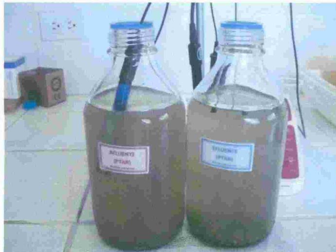
Fotografía Nº 04: Muestra compuesta de aguas residuales del afluente y efluente de la Planta de Tratamiento de Aguas Residuales. Laboratorio de análisis fisicoquímico. Ayacucho, 2010.
