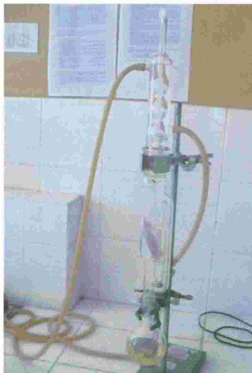
Fotografía Nº 07: Proceso de extracción de grasas y aceites en el equipo de Soxhlet, Laboratorio de análisis fisicoquímico de la Planta de Tratamiento de Aguas Residuales Totorá. Ayacucho, 2010.
