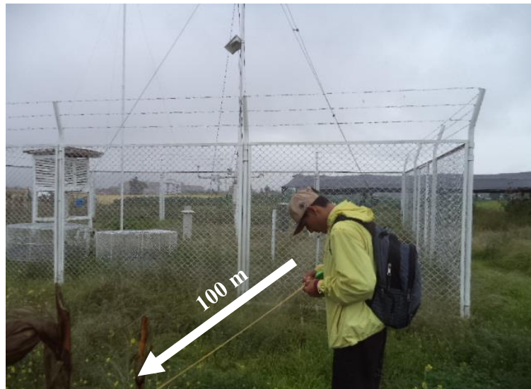
Figura 2.30. Medición de la distancia a barlovento en la estación del INIA
