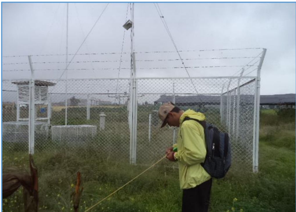
Fotografía 10. Medición de la distancia a barlovento en una superficie verde de poca altura de la estación meteorológica del INIA Fuente: elaboración propia
