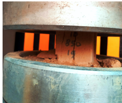
(b) Probeta luego de ser sometida al ensayo de rotura.
