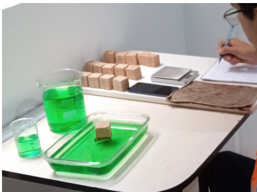
(a) Probeta sumergida 3mm en agua.
