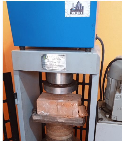
(b) Unidad de albañilería luego del ensayo a compresión.
