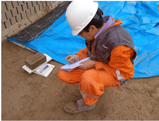
(a) Peso de ladrillo húmedo sobre una tara.
