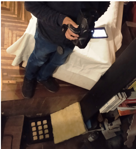
(a) Cámara FLIR GF306 apuntando a las probetas.
