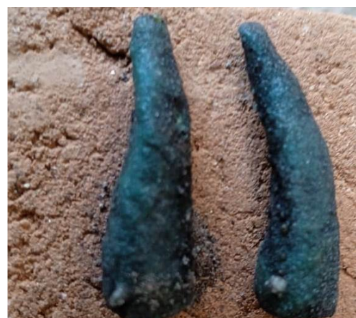
(b) Cono pirometrico luego de la quema.
