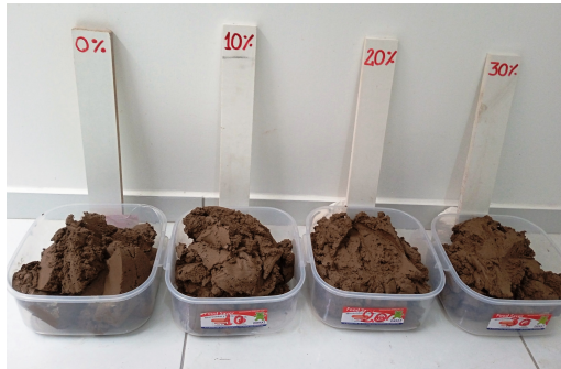
(a) Barro con distintas dosificaciones de diatomita.
