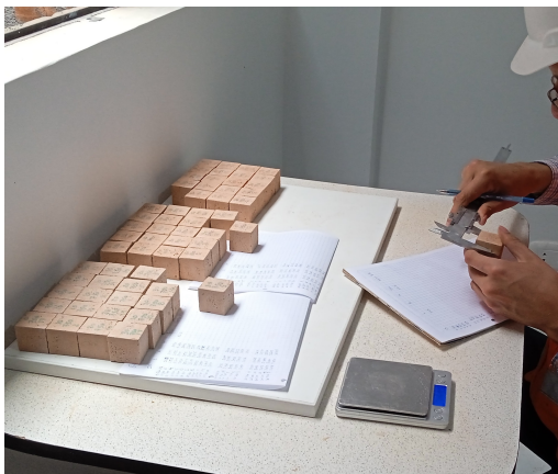
(a) Control de pesos medidas de la probeta.
