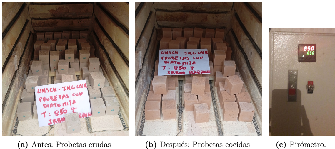
Figura 3.16: Cocción de probetas a 850 C.
