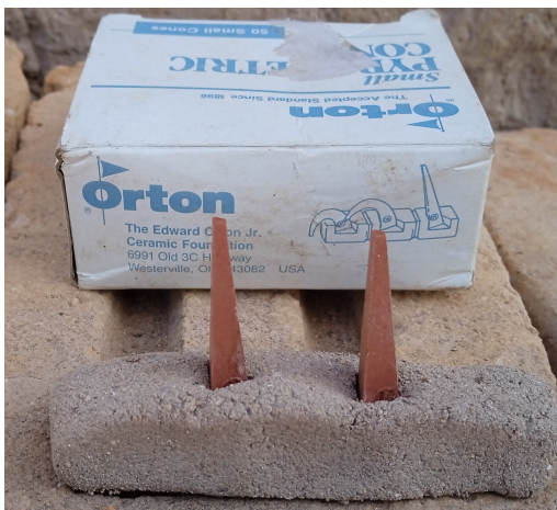
(a) Cono pirometrico antes de la quema.
