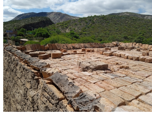
(b) Después de la quema: descenso uniforme de una altura.
