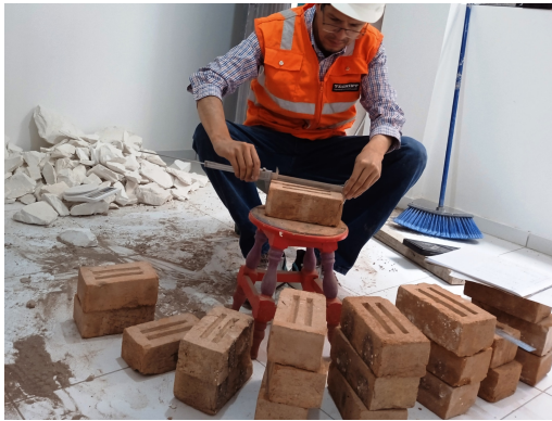
(a) Medida de los lados del ladrillo artesanal.
