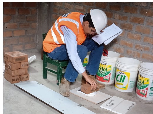
(b) Control de peso húmedo del ladrillo.
