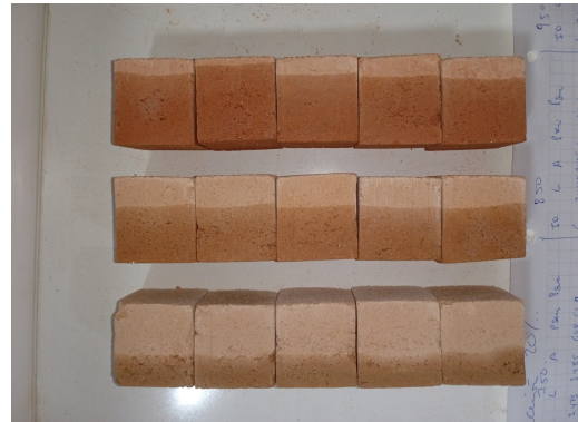
(b) Ladrillos luego de pa prueba de succión.
