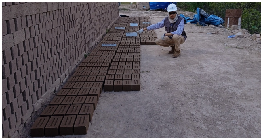
Figura 3.8: Secado de ladrillos al aire libre.
