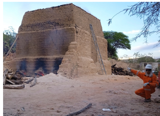
(b) Quema de ladrillos en horno volcán
