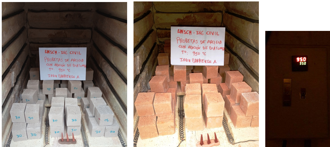
(a) Antes: Probetas crudas (b) Después: Probetas cocidas (c) Pirómetro.
