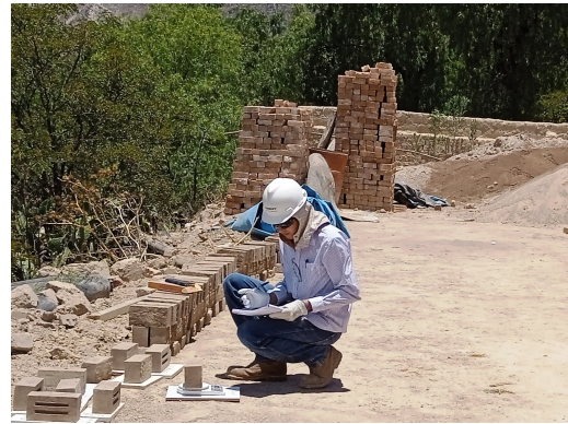
(b) Peso del ladrillo semiseco sin tara.
