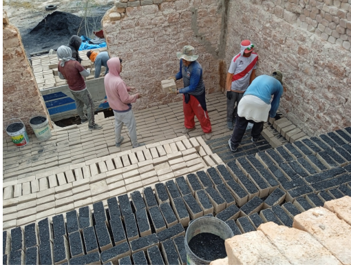
(a) Llenado del horno y colocación de carbón.
