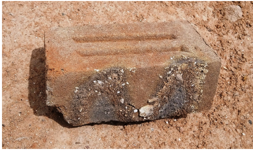
(a) Ladrillo mal cocido por exceso de carbón
