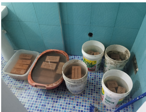
(a) ladrillos medidos, pesados y sumergidos en agua.
