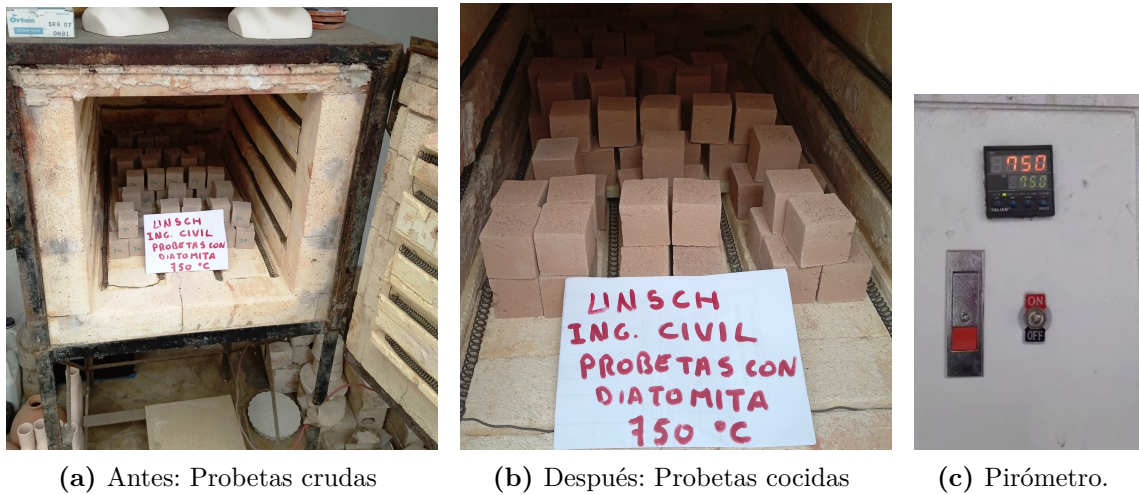
Figura 3.15: Cocción de probetas a 750 C.
