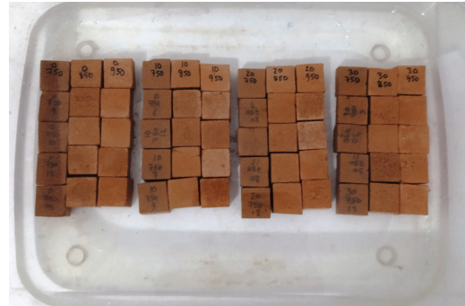
(b) Probetas sumergidas en agua por 24 h..
