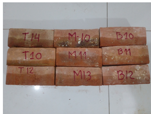
(b) Ladrillos luego de la prueba de succión.
