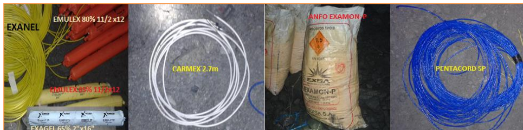
Fig. N° 27: Explosivos y accesorios para la voladura en tajeos
