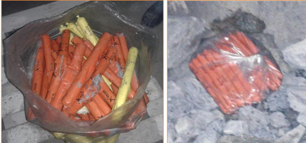
Fig. N° 73: Explosivos en mal estado en el polvorín y explosivos sobrantes en labor
