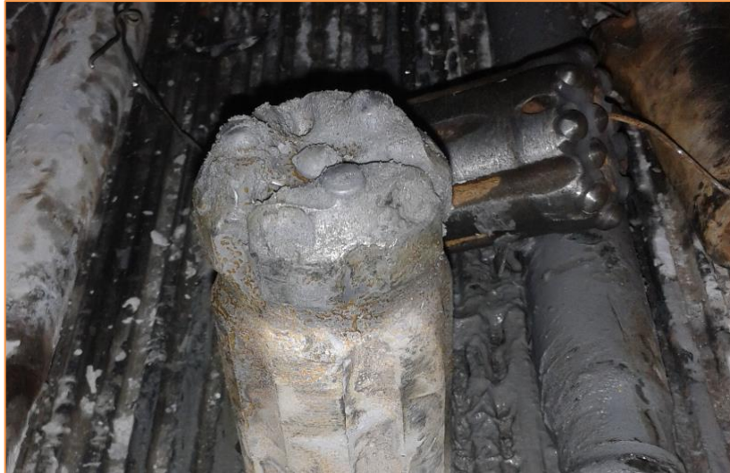
Fig. N° 72: Brocas con insertos totalmente desgastadas
