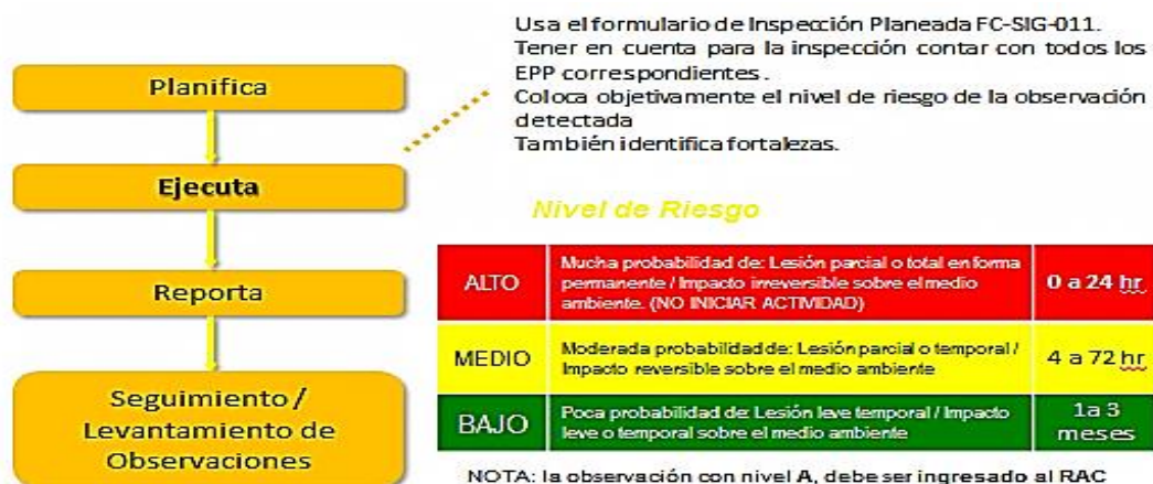
Fig. N° 37: Pasos para realizar la inspección
