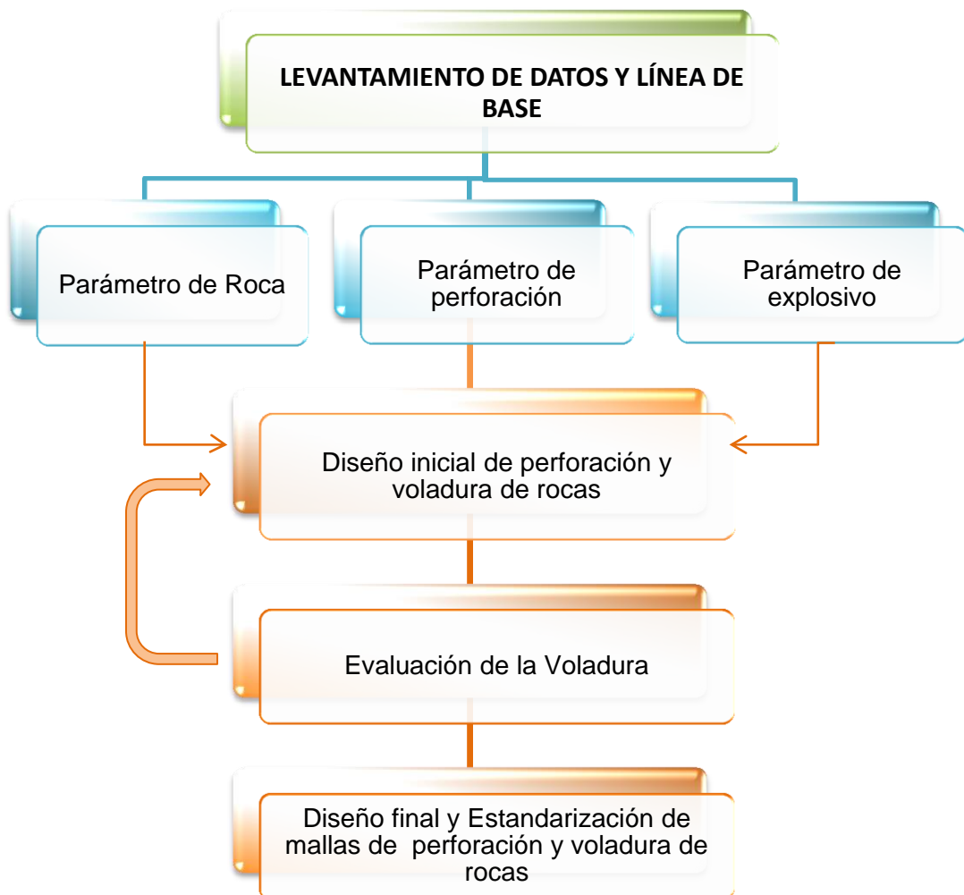
Fig. N° 66: Diagrama de Flujo para el diseño de mallas de perforación y voladura
