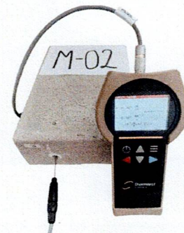
Fotografía 03: Medición de la temperatura, conductividad y resistencia térmica mediante uso del instrumento TLS-100.
