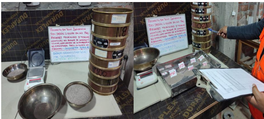
Figura 7 Inicio del tamizado con un control adecuado para el ensayo granulométrico
