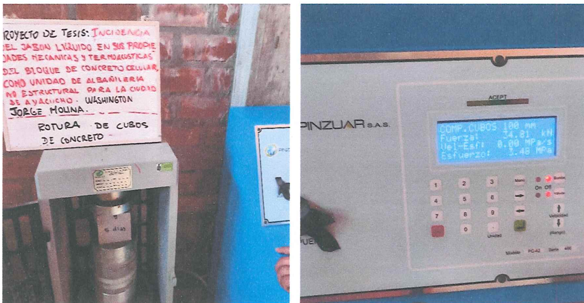
Fot: 03 Y 04; VISTA DE LA ROTURA DE TESTIGO N°2 Y LA PANTALLA DE LA MAQUINA
