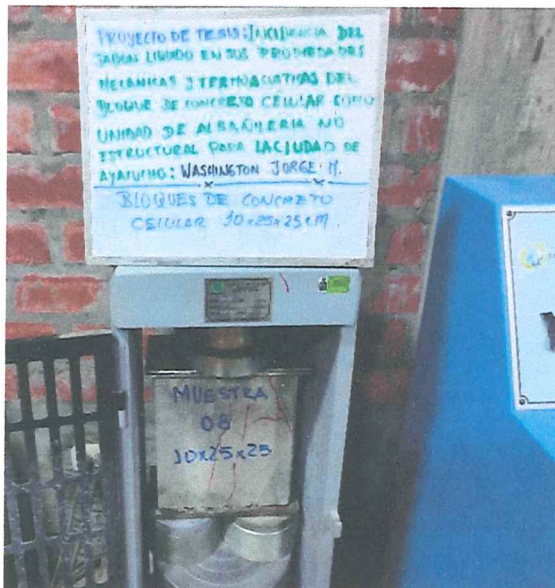
Fot: 03 Y 04; VISTA DE LA ROTURA DE TESTIGO N°8 Y LA PANTALLA DE LA MAQUINA
