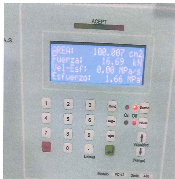
Fot: 03 Y 04; VISTA DE LA ROTURA DE TESTIGO N°2 Y LA PANTALLA DE LA MAQUINA
