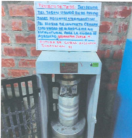
Fot: 01 Y 02; VISTA DE LA ROTURA DEL TESTIGO N°1 EN EL LABORATORIO
