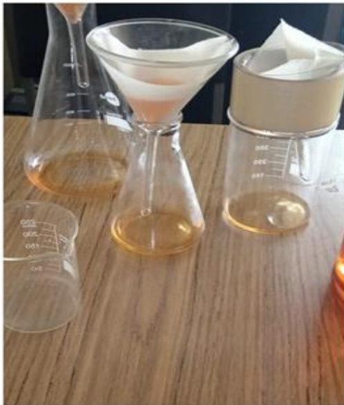
Filtración del extracto de semilla de palta
