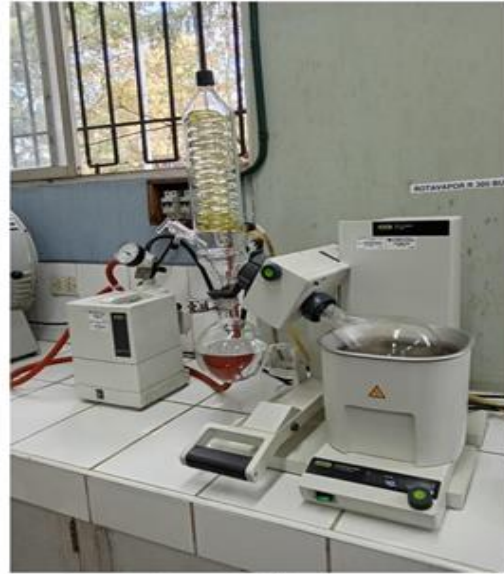
Concentracion del extracto de semilla de palta con rotovapor
