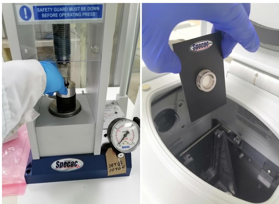
Fotografía 8. Preparación de pellets y lectura por el FTIR
