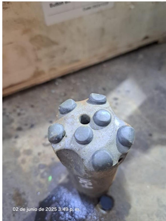
Broca de perforación desgastada
