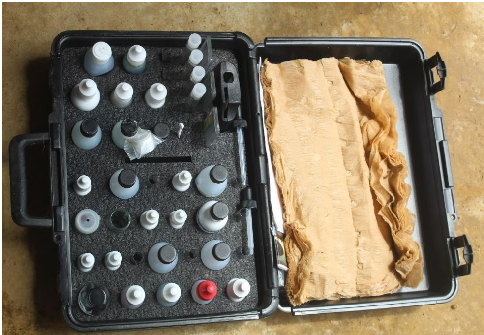
Foto 8. Laboratorio portátil HI3817-HANNA para los análisis de las características físicas y químicas del agua en los diferentes tratamientos. Cusco 2021.
