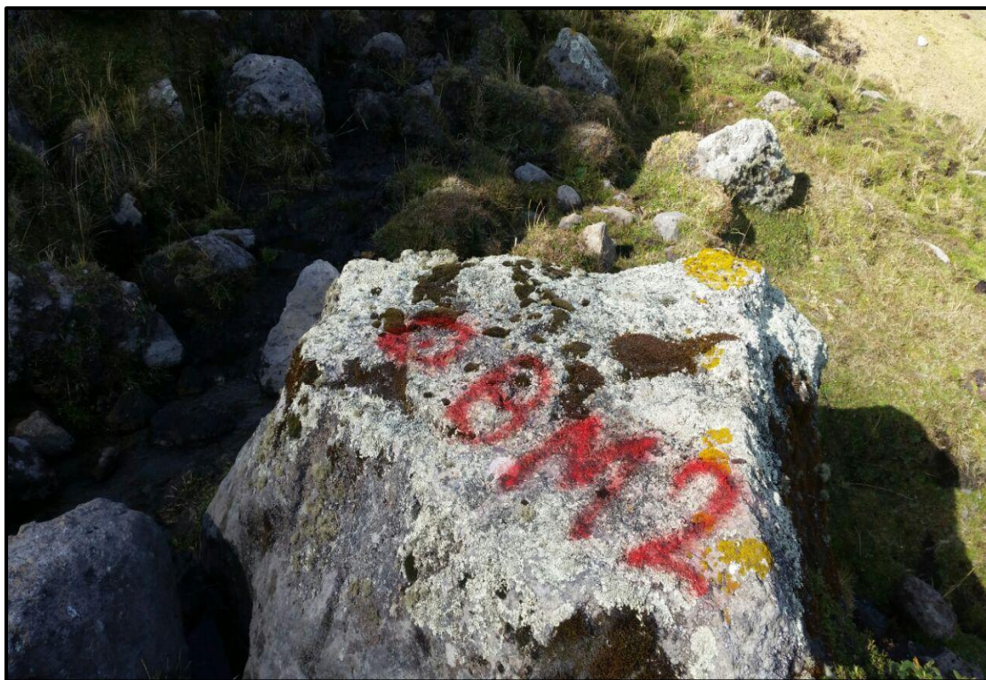
Fotografía 9. Pintado y marcado de los puntos de control – BM 02 con esmalte rojo, ubicado en una roca fija cerca a la captación proyectada.
