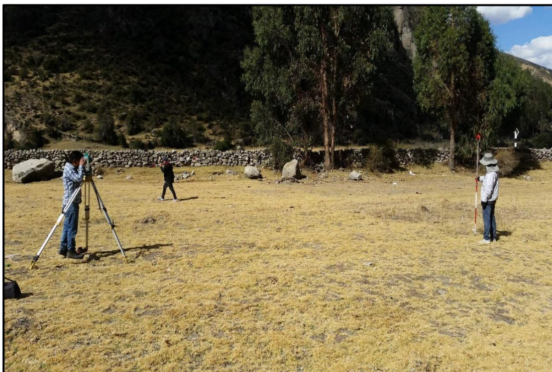
Fotografía 10. Equipo técnico haciendo levantamiento topográfico de área de influencia del proyecto (zona de captación, línea de conducción, parcelas de riego y terreno asignado para el invernadero).
