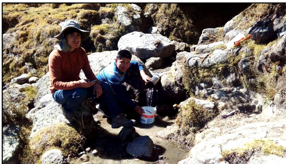
Figura 3.9. Aforamiento de puquial de Jatumpampa, método volumétrico
