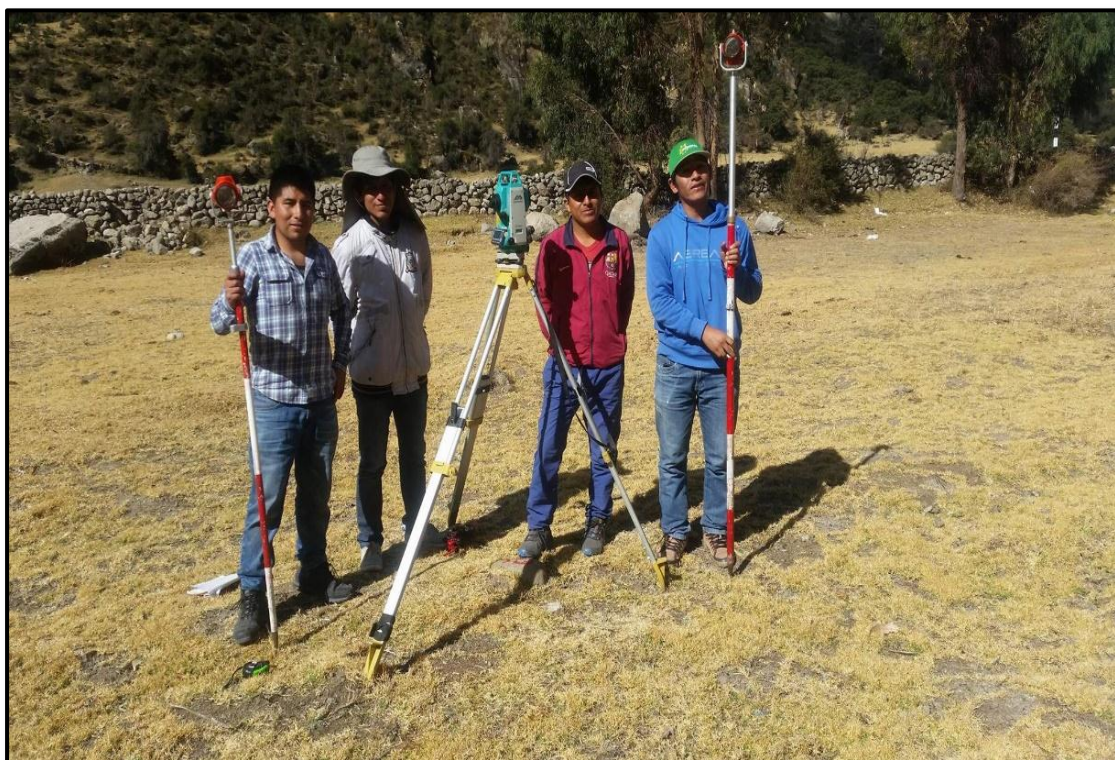
Fotografía 6. Equipo técnico de levantamiento topográfico, se utilizó una estación total marca SOKKIA y GPS GARMIN OREGON 650.
