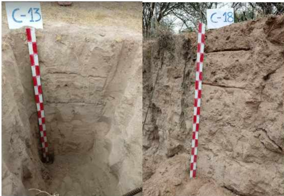
Foto R.3. Apertura de calicata para el análisis de suelo para procesar y obtener CUMs, asimismo en el diseño agronómico
