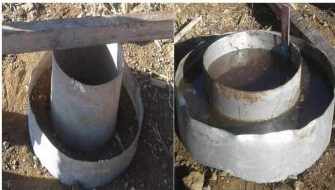
Foto R.2. Prueba de infiltración, una vez procesada se obtendrá la velocidad de infiltración
