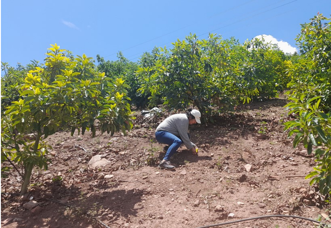
Foto 5. Determinado el rango de pendiente en porcentaje mediante uso de un eclímetro topográfico en el centro poblado de Magnupampa del valle de Torobamba
