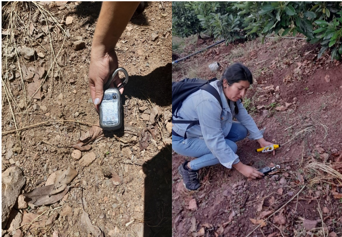
Foto. 6. Determinado las coordenadas geográficas y rango de pendiente con un navegador GPS y eclímetro en el centro poblado de Patibamba del valle de Torobamba
