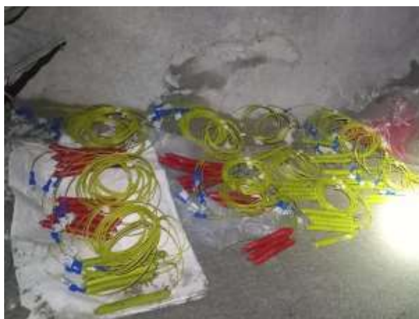
Figura 6: Accesorio de voladura Fanel
