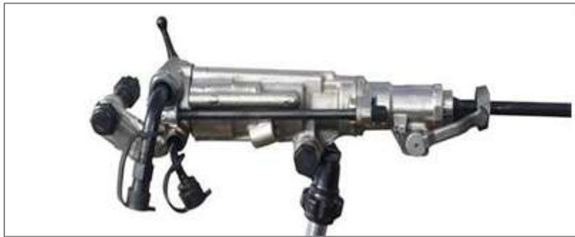
Figura 2: Perforacion convencional con máquina jackleg modelo RN-250X
