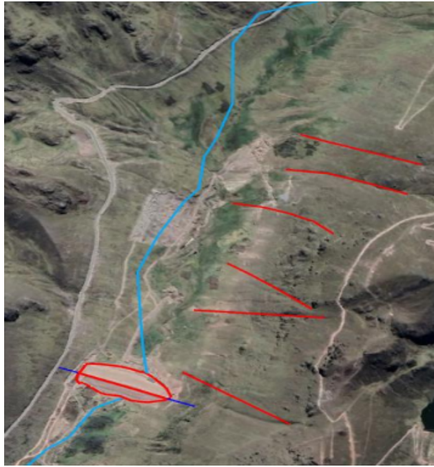
FIGURA 2.9 Vista del rumbo de las lineaciones (fallas tipo normales - líneas rojas).
