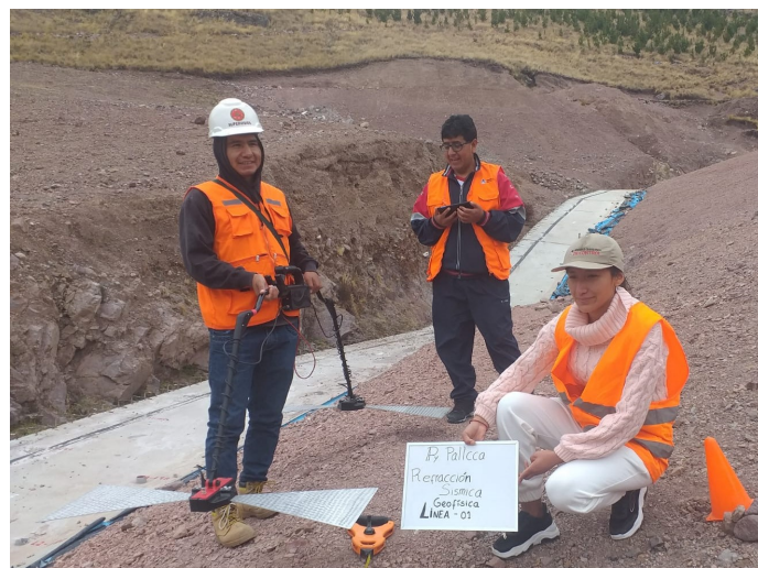
Figura C.25 Ensayo de refracción sísmica. Fuente: Elaboración propia
