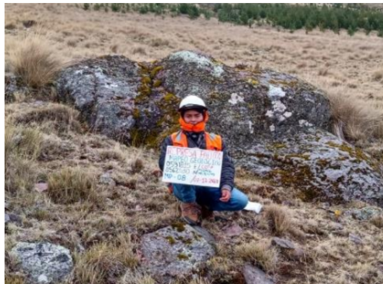
FIGURA 2.8 Vista del vaso margen izquierdo (aguas abajo), afloramiento de macizo rocoso (roca ígnea-volcánica), se clasifica como roca buena tipo II. Fuente: Elaboración propia
