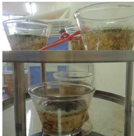
Liofilizado congelado a - 60 °C x 24 h y sublimado a - 80 °C x 48 h
