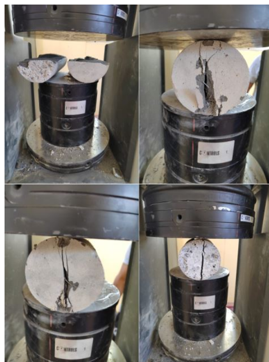
Figure 18: Probetas ensayadas a tracción indirecta
