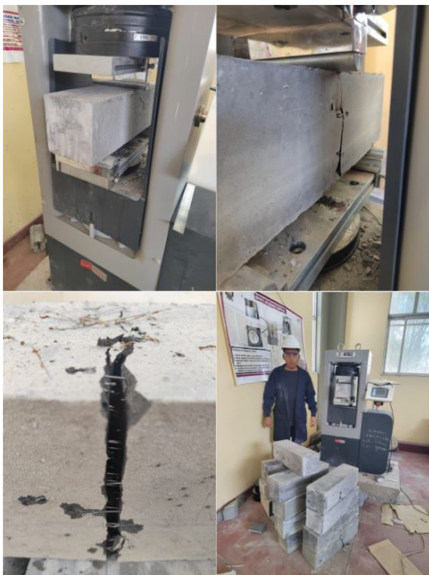
Figure 20: Probetas ensayadas a flexión
