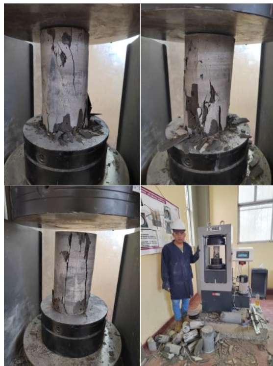
Figure 17: Probetas ensayadas a compresión
