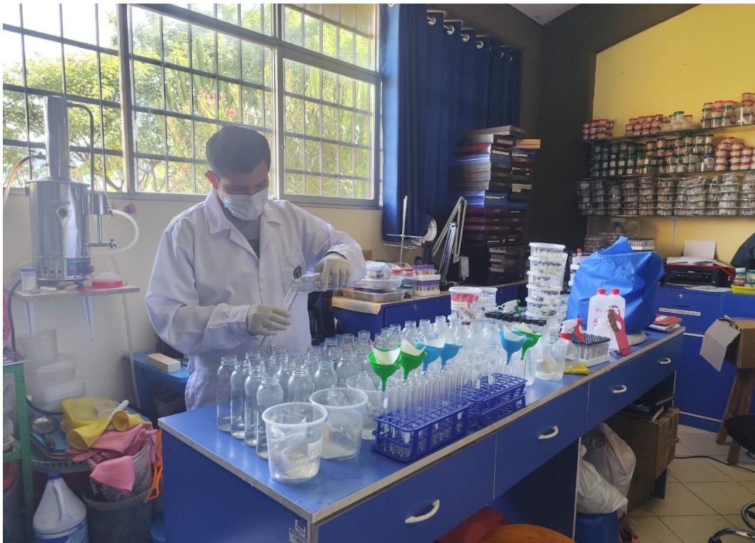
Anexo 11. Filtración de muestras de agua para la medición de nutrientes de los arroyos que escurren de tres bofedales altoandinos, en la localidad de Llachoccmayo, Chiara. Ayacucho 2021.
