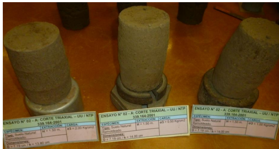
Figura 53: Especímenes de suelo de grano fino CL (C-04'), fallados por abultamiento
