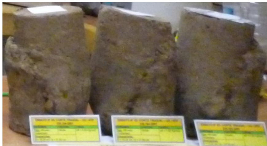
Figura 58: Probetas de ensayo triaxial UU (GE-04) con modo de falla por corte para \sigma_3 = 0.5, 1.0 y 2 \text{ kg/cm}^2 en ese orden de izquierda a derecha de la figura.
