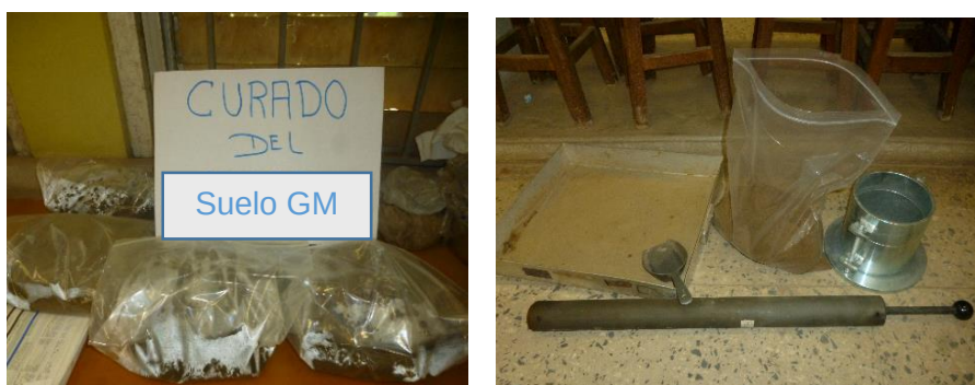
Figura 19: Ensayo Proctor modificado previo curado del suelo granular GM.
