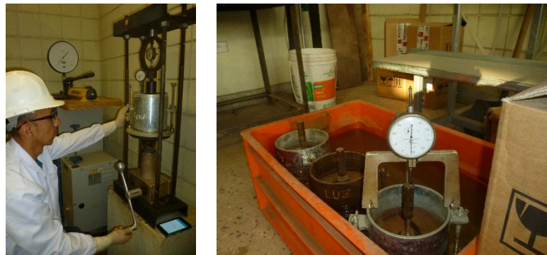
Figura 21: Ensayos CBR y saturación antes de ejecutar la prueba
