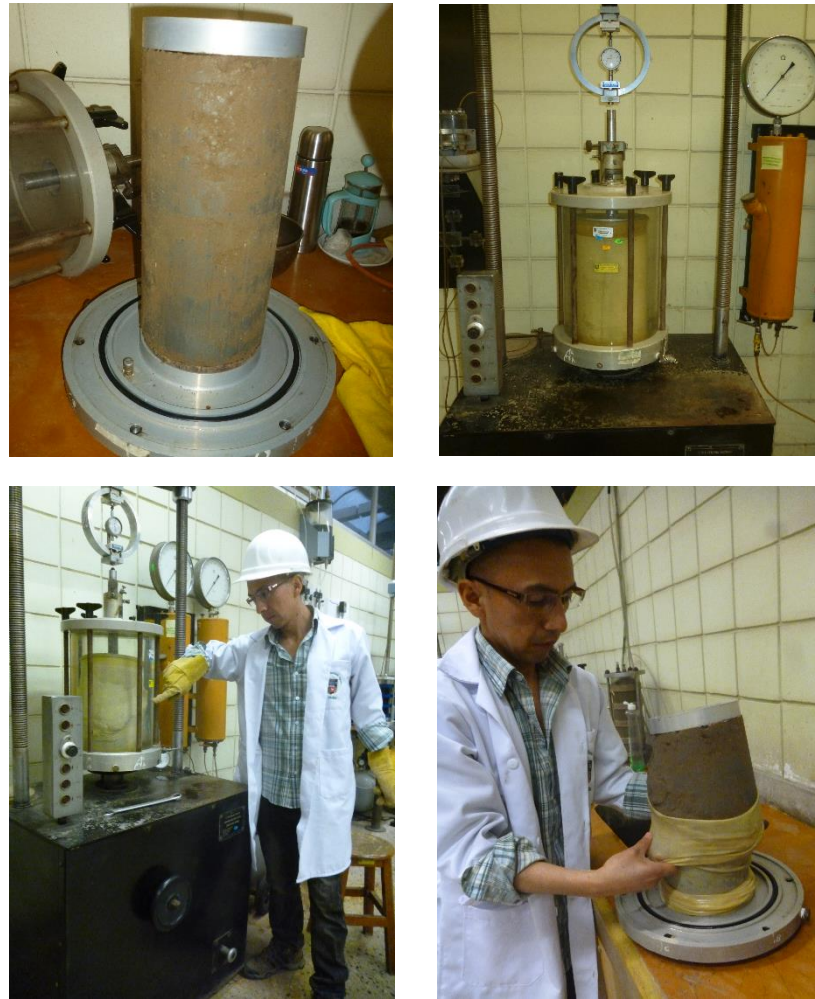
Figura 23: Ensayo de compresión triaxial UU para un suelo granular grueso GM.
