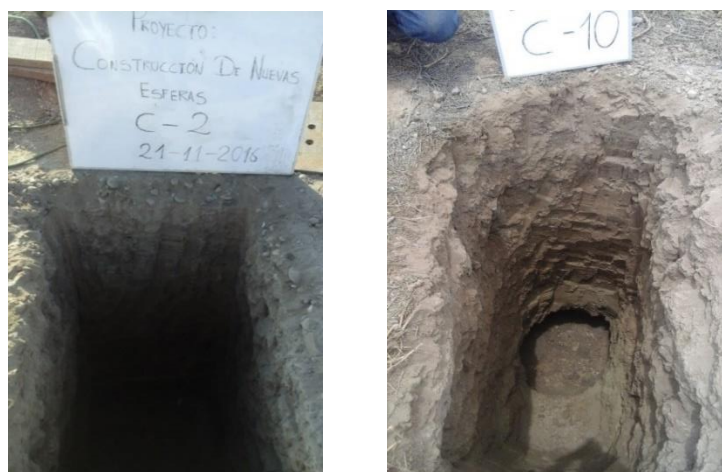
Figura 11: Ensayos de excavación directa de calicatas C-2 y C-10
