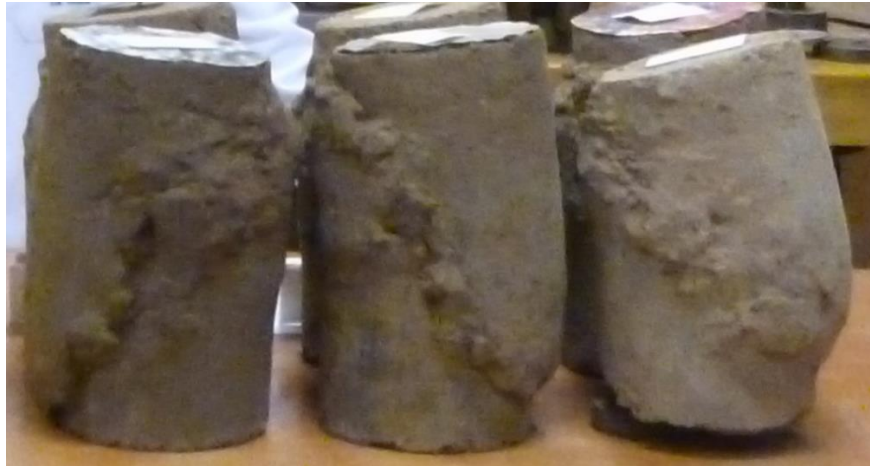
Figura 58: Probetas de ensayo triaxial UU (GE-04) con modo de falla por corte para \sigma_3 = 0.5, 1.0 y 2 \text{ kg/cm}^2 en ese orden de izquierda a derecha de la figura.
