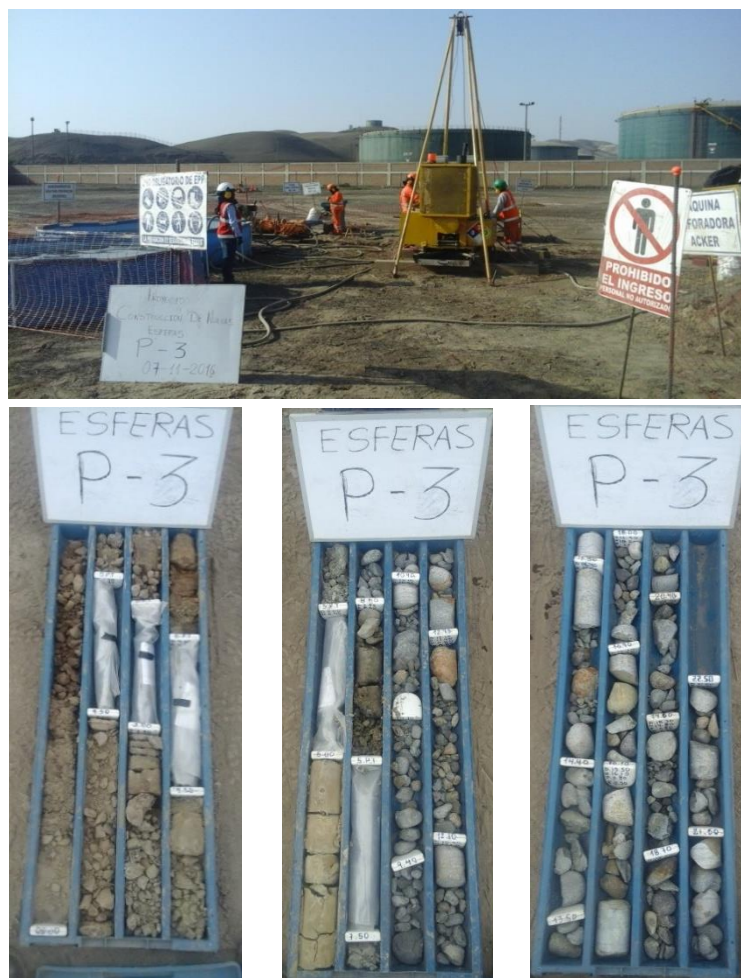
Figura 10: Ensayo de perforación diamantina P-3 y su testigo extraído
