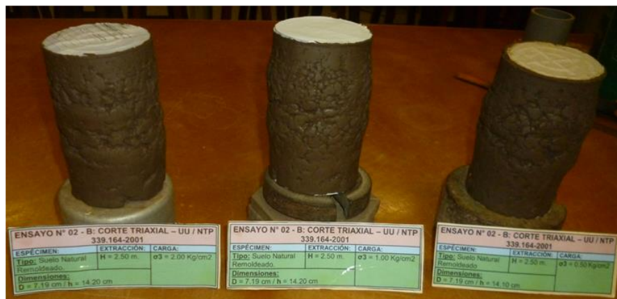
Figura 52: Especímenes de suelo de grano fino CH (suelo crítico – GC), fallados por abultamiento
