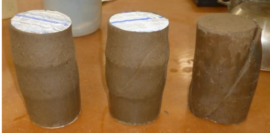
Figura 55: Probetas de ensayo triaxial UU (GE-01) con tres tipos de modo de falla para \sigma_3 = 0.5, 1.0 y 2 \text{ kg/cm}^2 en ese orden de izquierda a derecha de la figura.
