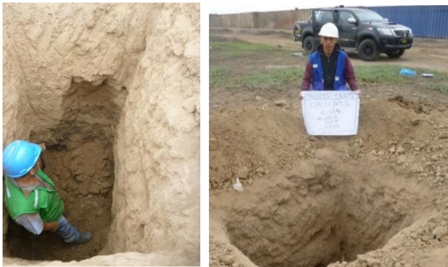
Figura 24: Calicata C-04' ubicada en área de influencia del tanque proyectado
