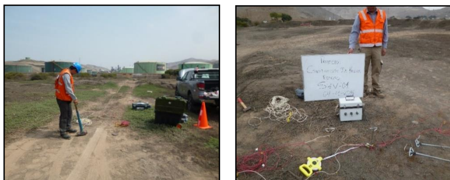
Figura 9: Estudio de refracción sísmica (lado izquierdo) y sondaje eléctrico vertical (lado derecho)
