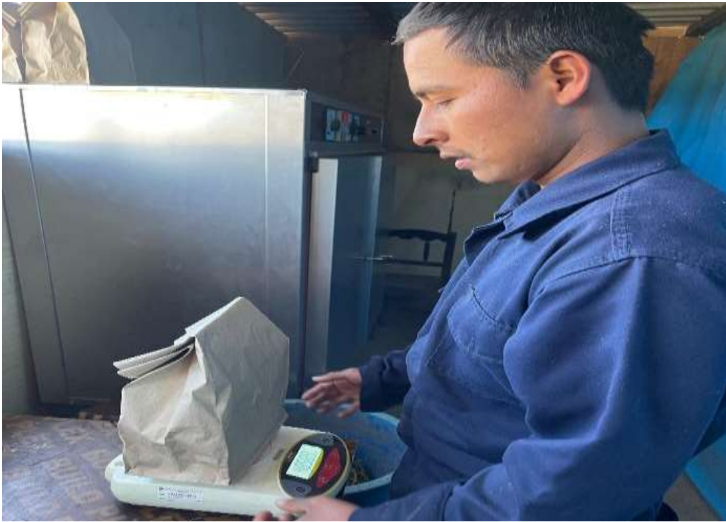
Foto 17. Pesaje de muestra pasado 48 horas
