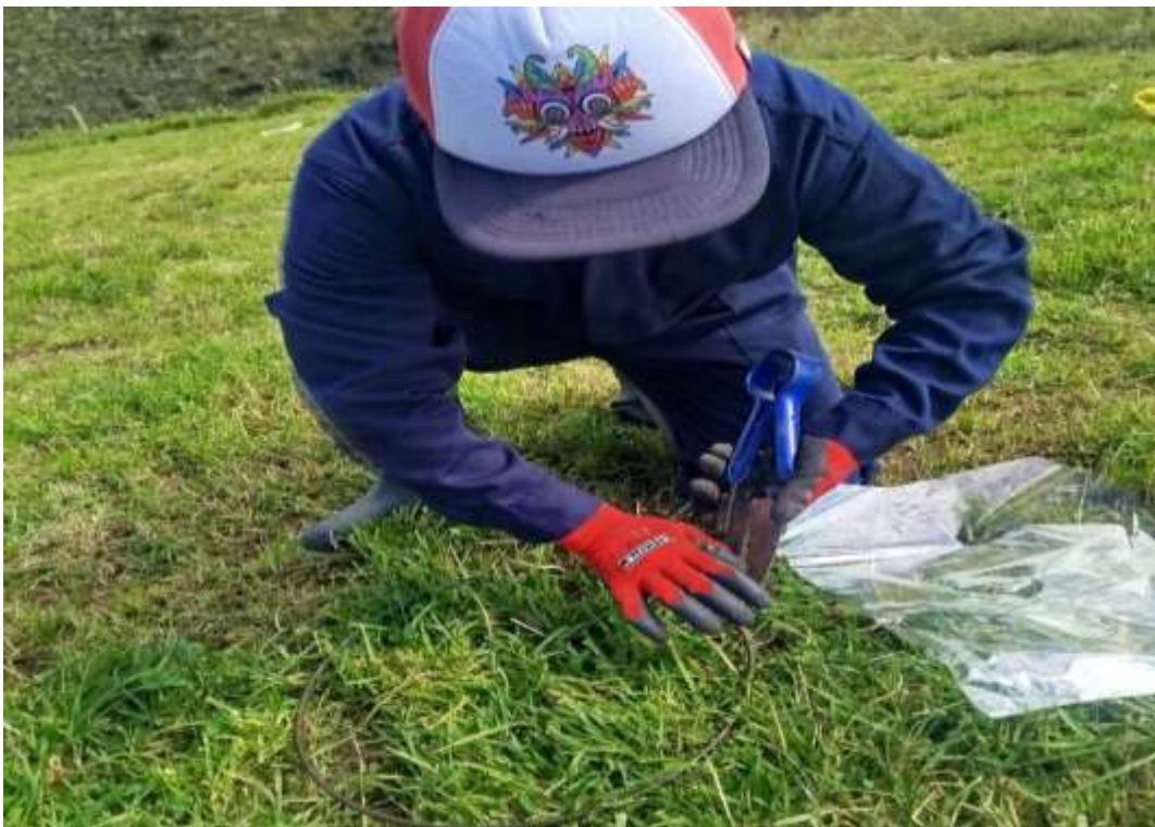
Foto 6. Corte a ras dentro del aro
