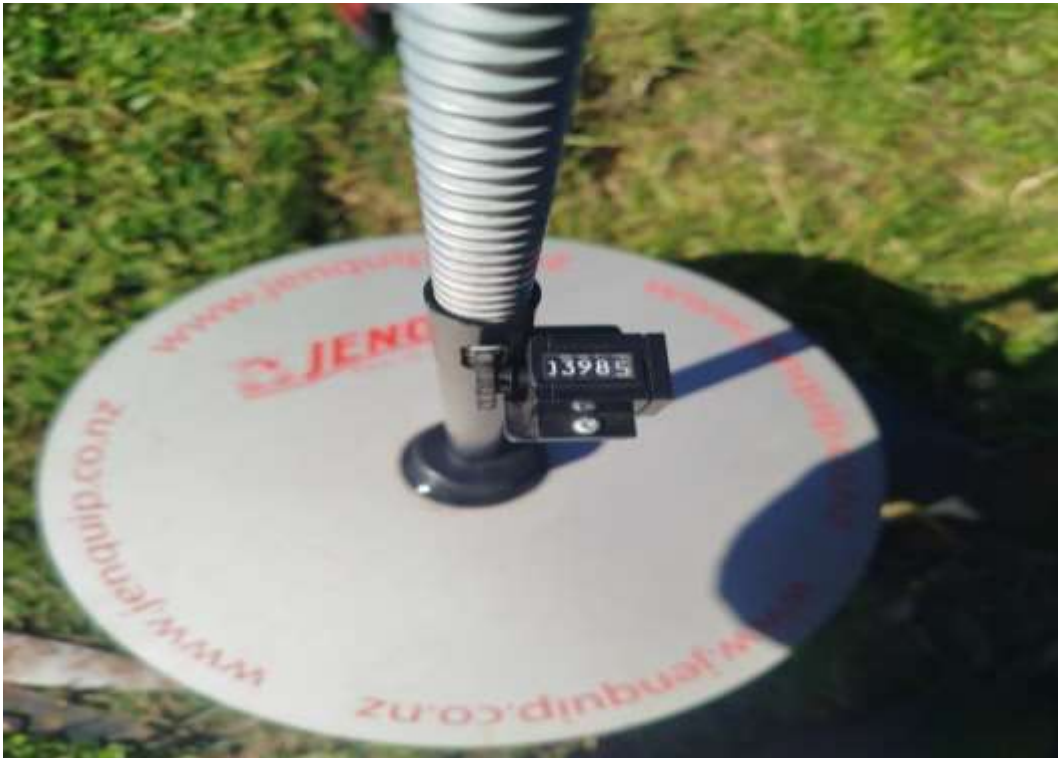
Foto 3. Plato, bastón ranurado, marcador altura inicial-final
