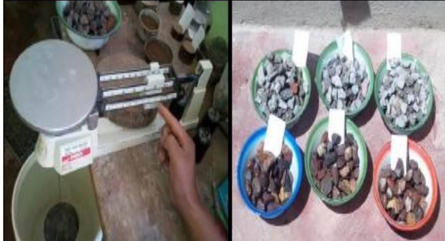
Figura 2.17. Selección de agregados grueso-natural
