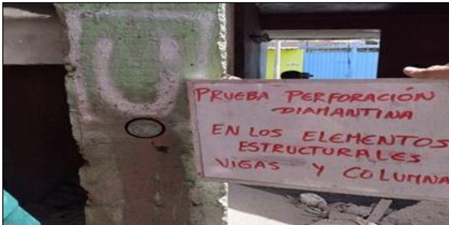
Figura 2.3. Extracción de espécimen de la vivienda N° 2
