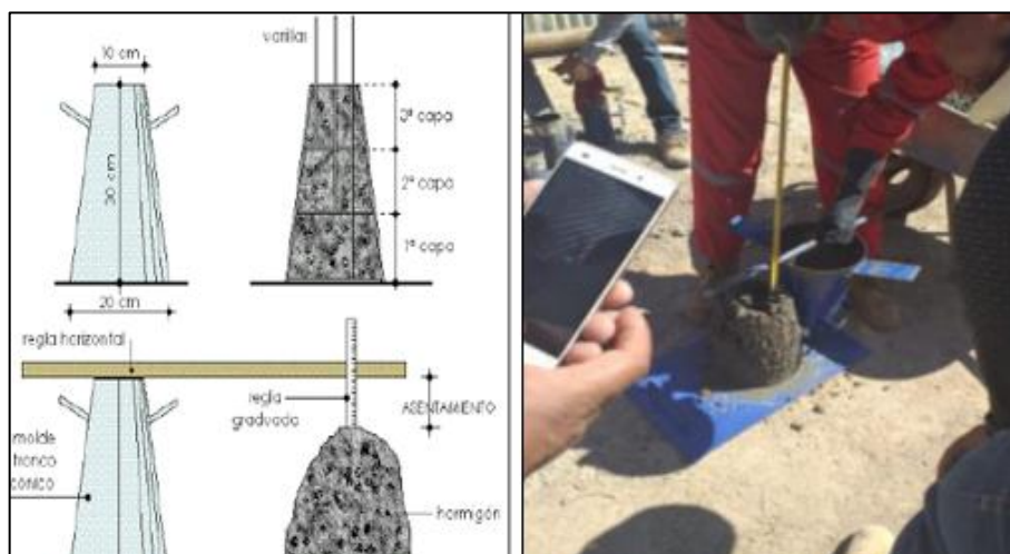
Figura 2.20. Prueba de Slum
