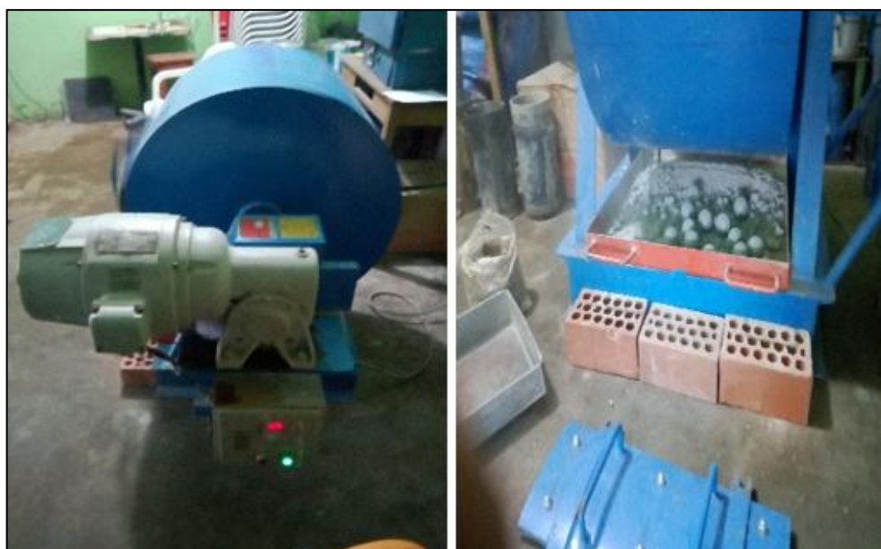
Figura 1.5. Equipos de abrasión los ángeles
