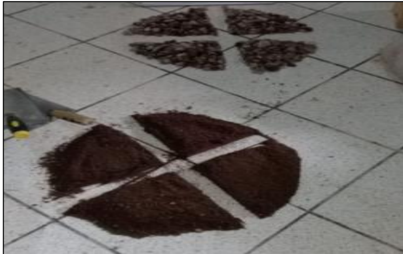
Figura 2.15. Selección de agregado fino-cuarteo
