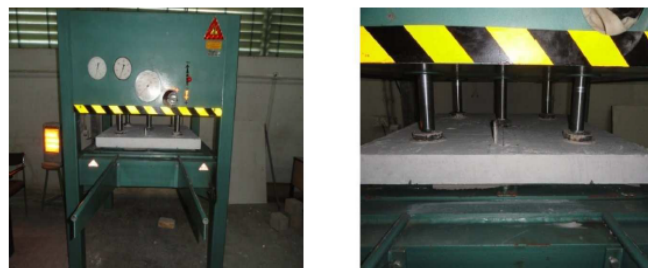
Figura 2.11: Configuración de prueba de la losa de BubbleDeck de dos vías.
