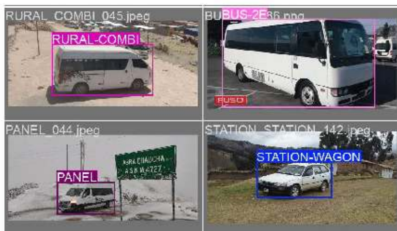
Figura 78: Detección de RC-B2E-PA-SW Fuente: Imagen propia
