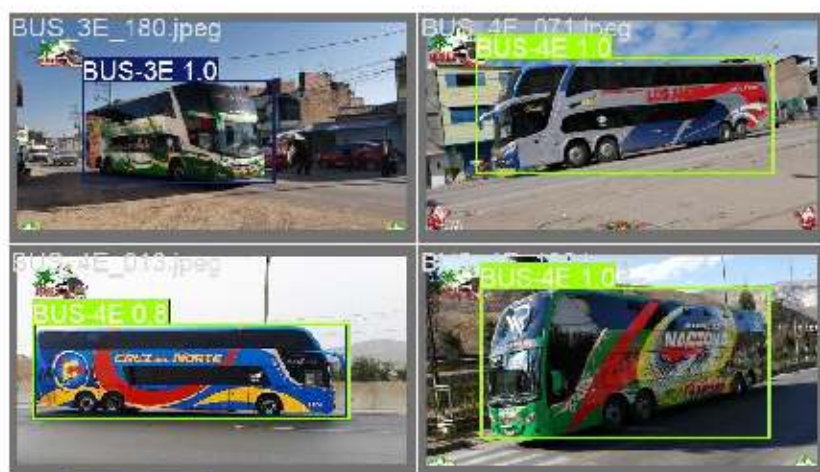
Figura 80: Detección y % de precisión B3E(1.0)-B4E(1.0)-B4E(0.8)-B4E(1.0) Fuente: Imagen propia
