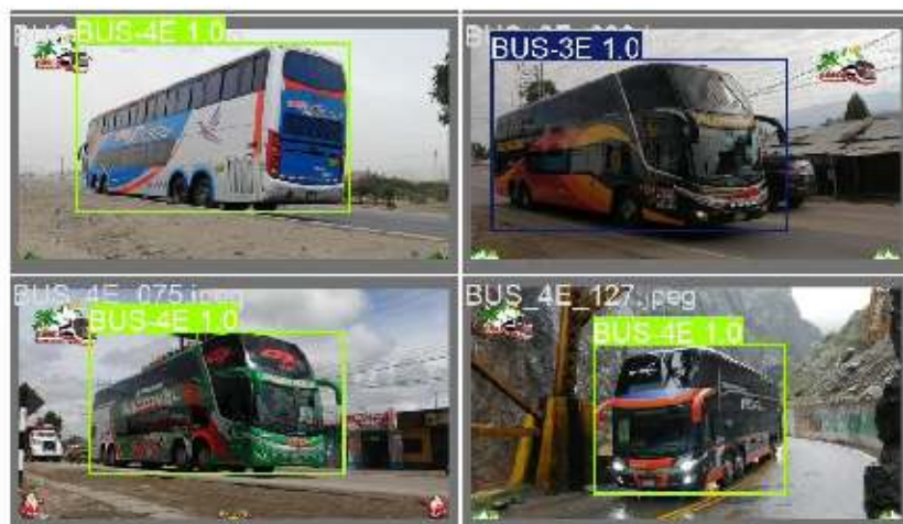
Figura 82: Detección y % de precisión B4E(1.0)-B3E(1.0)-B4E(1.0)-B4E(1.0) Fuente: Imagen propia
