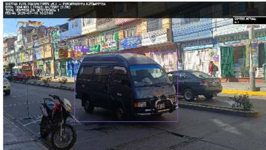
Figura 100: Dia domingo: Detección de RC con tracking ID:3,, 97% de precisión Fuente: Imagen propia
