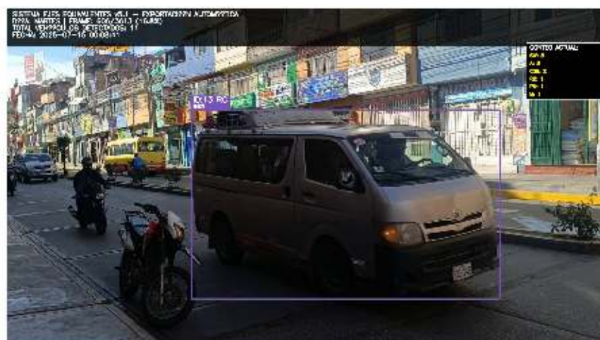
Figura 91: Día martes: Detección de RC con tracking ID:13 y precisión 96 % Fuente: Imagen propia
