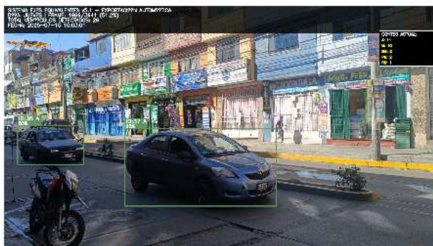
Figura 95: Dia jueves: Detección de A con tracking ID:37 y 38 registrado en el contador Fuente: Imagen propia
