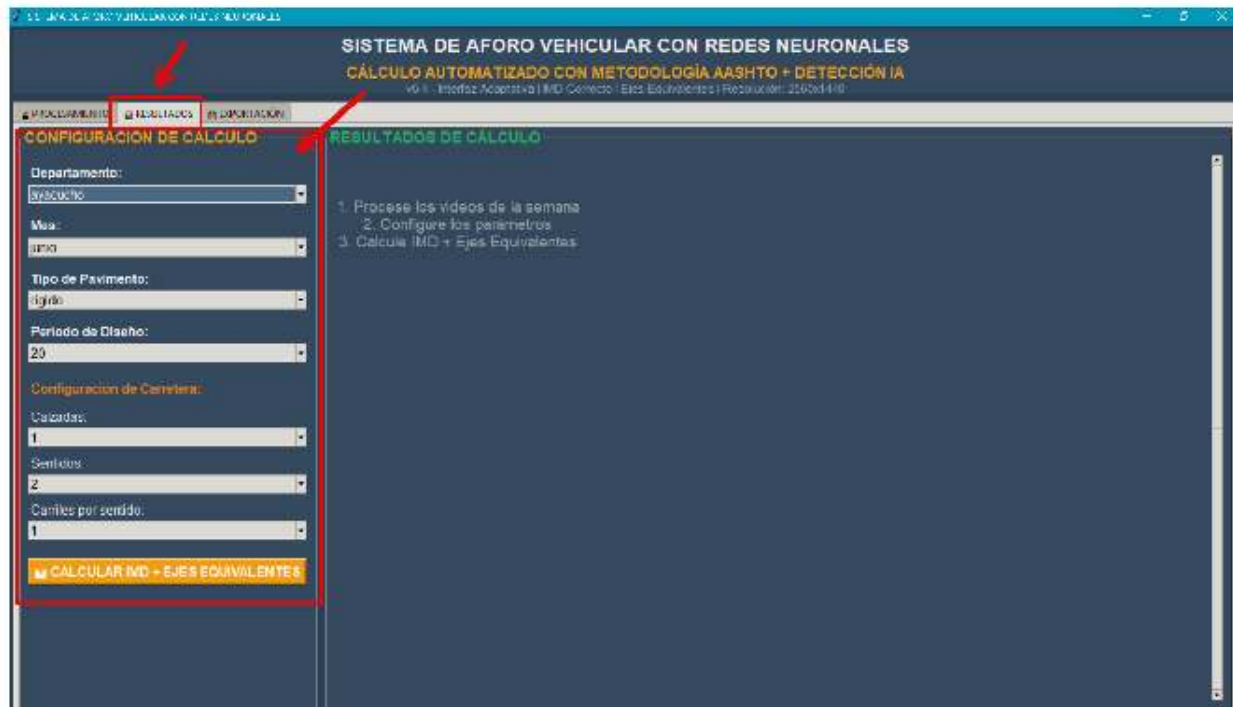
Fig. 10 Panel de configuración de parámetros para cálculo de ejes equivalentes
