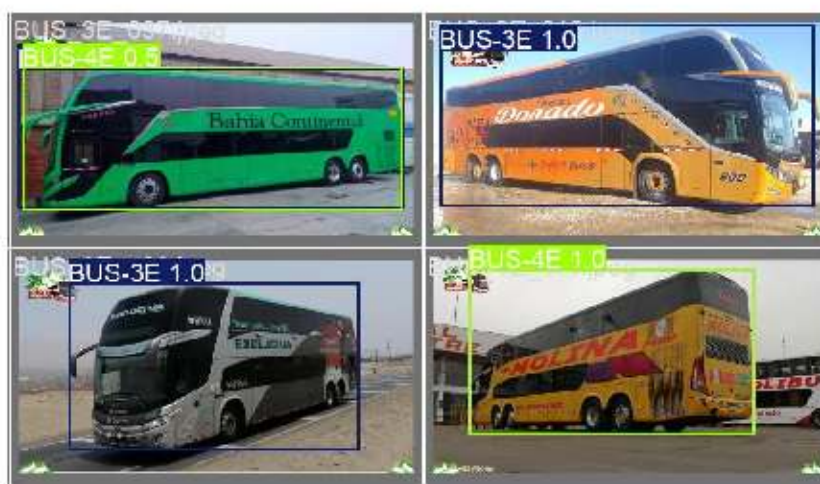
Figura 81: Detección y % de precisión B4E(0.5)-B3E(1.0)-B3E(1.0)-B4E(1.0) Fuente: Imagen propia
