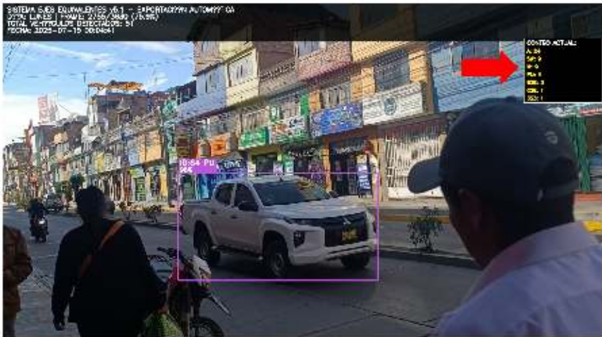
Figura 89: Día lunes: Detección de Pick Up (PU) con tracking ID:54, registrado en el contador Fuente: Imagen propia
