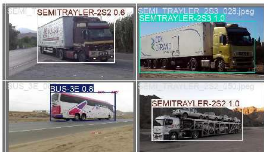
Figura 87: Detección y % de precisión 2S2(0.6)-2S3(1.0)-B3E(0.8)-2S2(1.0) Fuente: Imagen propia
