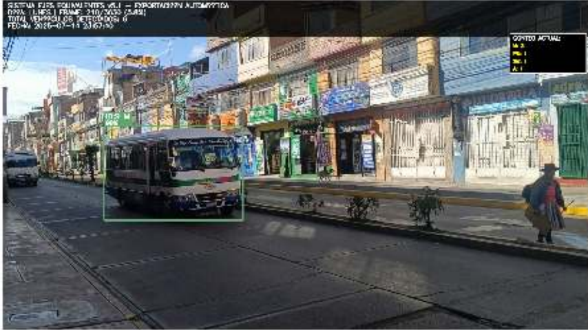
Figura 88: Dia lunes: Detección de Microbus (M) con tracking ID:9, precisión 96 % Fuente: Imagen propia
