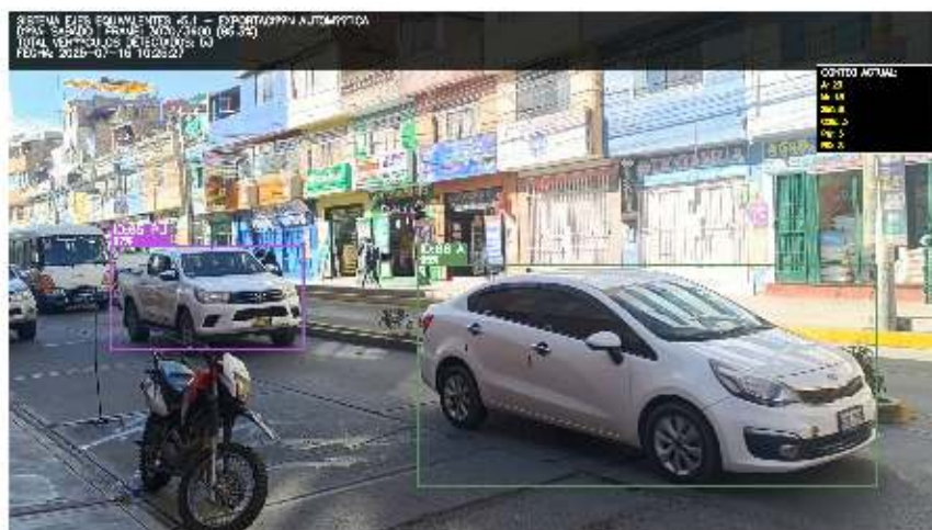
Figura 99: Día sábado: Detección de A y PU con tracking ID:66 e ID:65 respectivamente Fuente: Imagen propia
