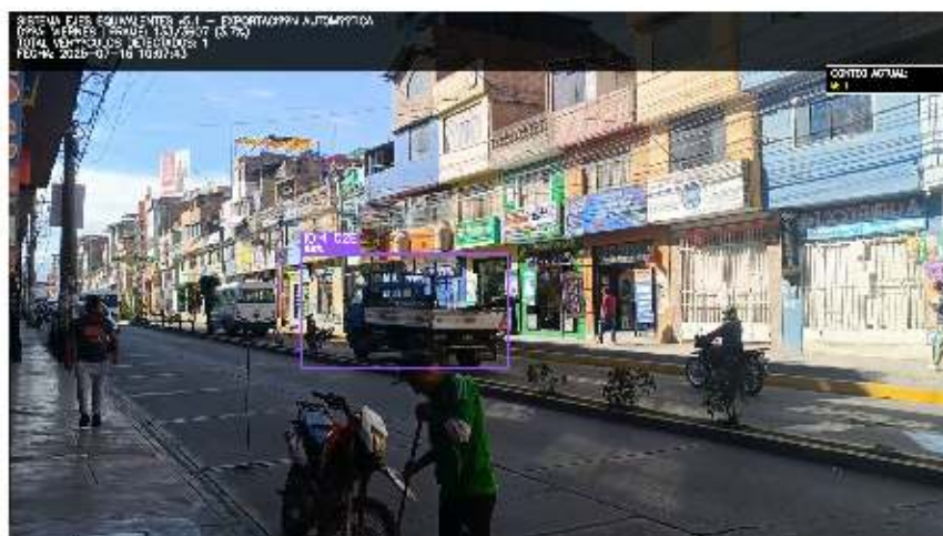
Figura 96: Dia viernes: Detección de C2E con tracking ID:4, registrado en el contador Fuente: Imagen propia
