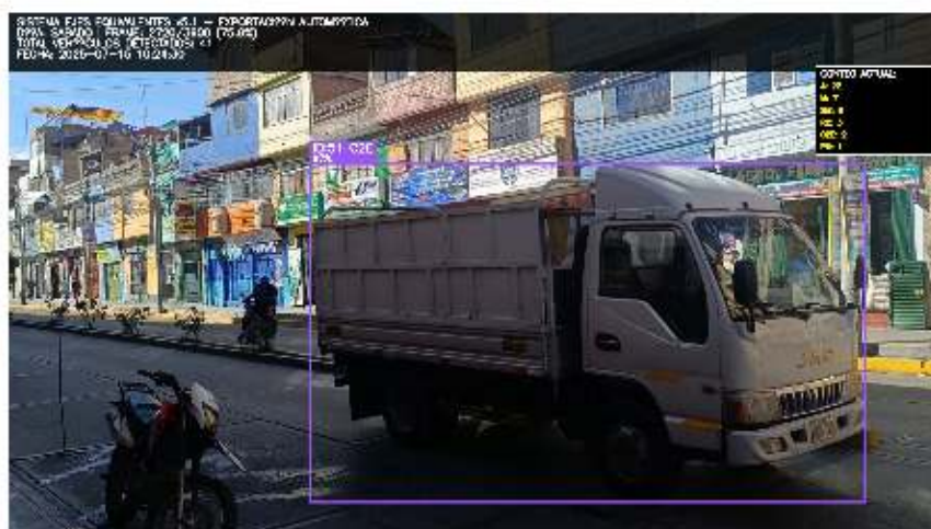
Figura 98: Día sábado: Detección de C2E con tracking ID:51, 97 % de precisión Fuente: Imagen propia
