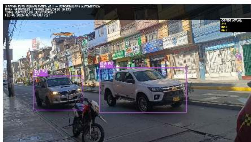
Figura 92: Día miércoles: Detección de PU con tracking ID:8 y ID:9 Fuente: Imagen propia
