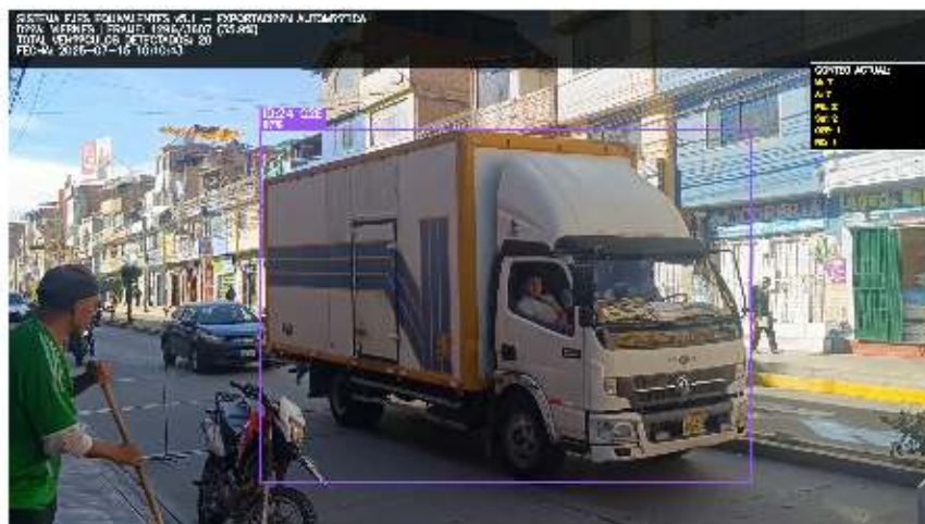
Figura 97: Día viernes: Detección de C2E con tracking ID:24, 97 % de precisión Fuente: Imagen propia
