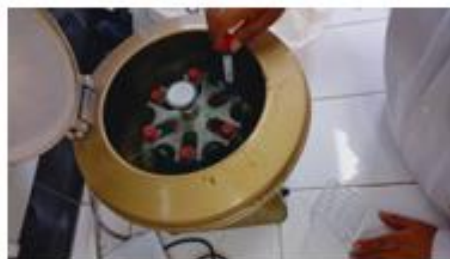
Centrifugar para separar la solución por densidad
