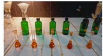
Preparación a diferentes concentraciones para determinar la curva de calibración
