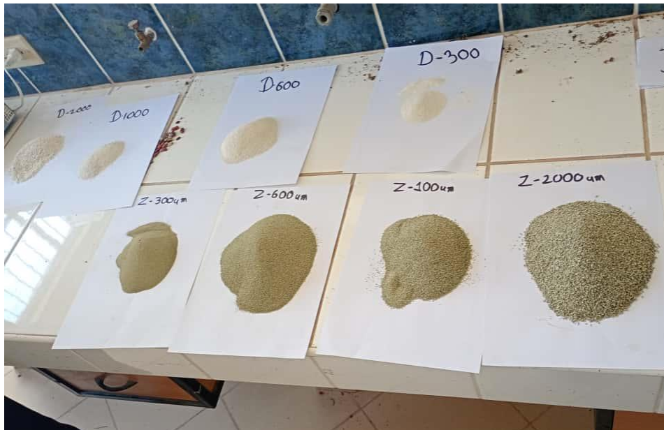
Tamizaje, selección y clasificación de los materiales retenedores de acuerdo al requerimiento del experimento.
