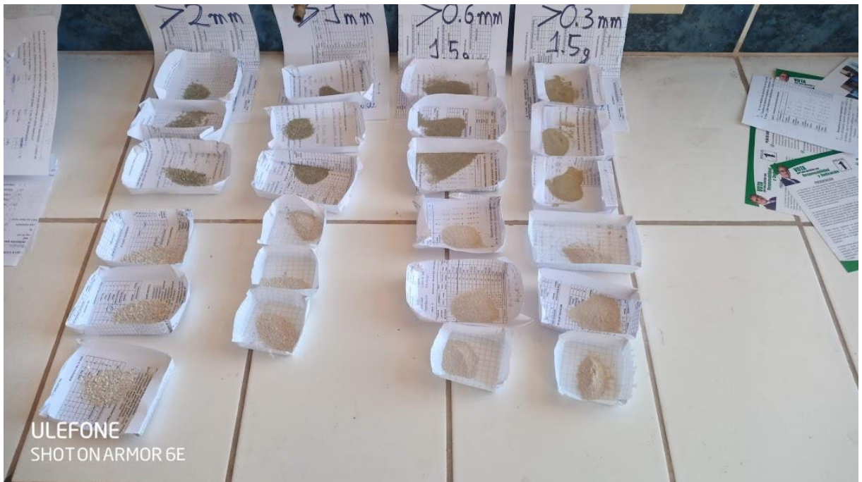
Proceso de pesaje con balanza de precisión de la diatomita (1.5 g) de distintas granulometrías para sus respectivos tratamientos.
