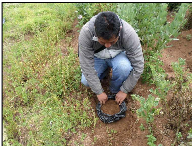
Figura 11. Toma de muestra del suelo para su análisis físico del suelo
