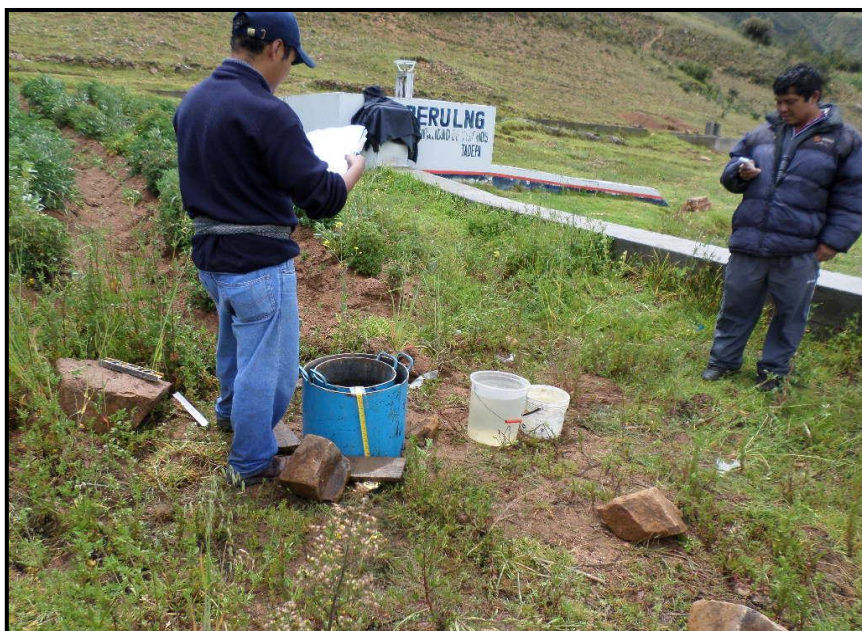
Figura 14. Evaluación en campo de la infiltración del agua en el suelo
