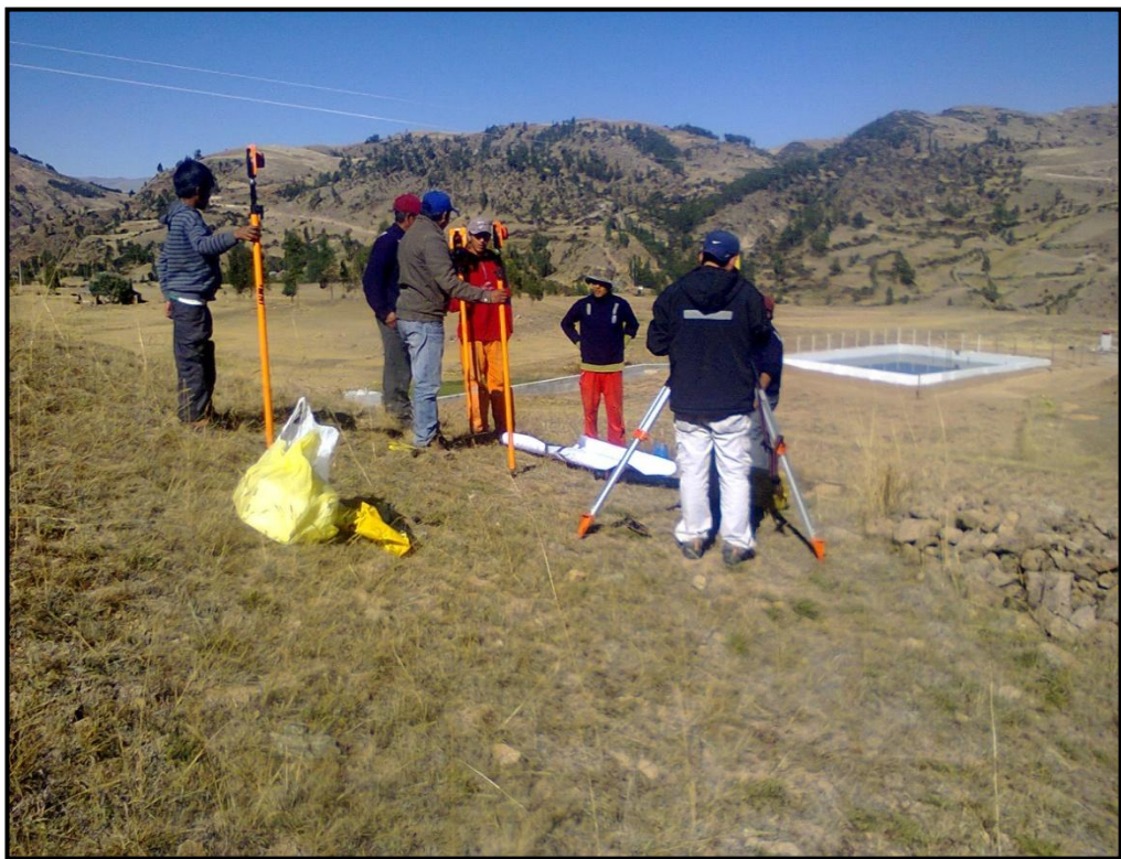
Figura 8. Levantamiento topográfico de las obras existentes
