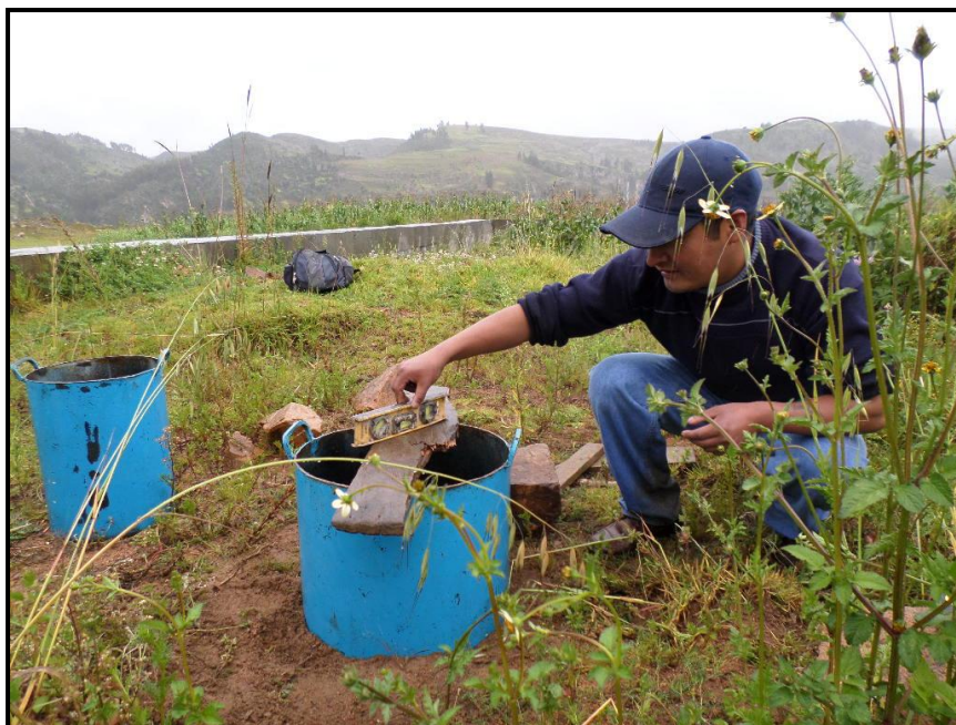
Figura 13. Comprobando la horizontalidad del cilindro con el nivel
