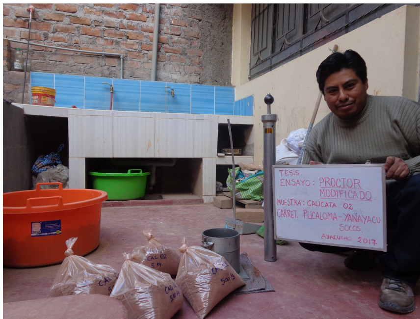
Figura 3.17: Ensayo de compactación (Geotecnia & Ingeniería, 2018).
