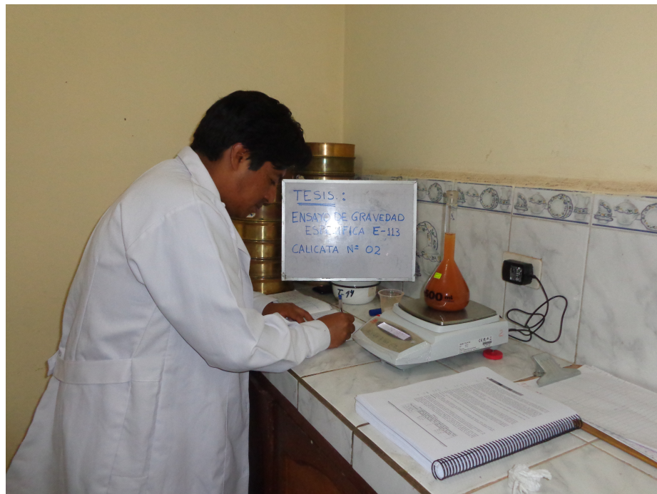
Figura 3.15: Pesado del picnómetro con la muestra (Geotecnia & Ingeniería, 2018).
