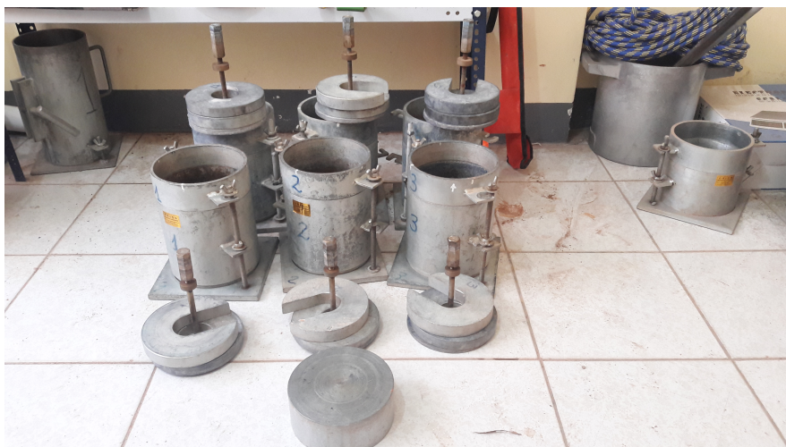
Figura 3.4: Molde de 6 pulgadas y sus Contrapesos (Geotecnia & Ingeniería, 2018).
