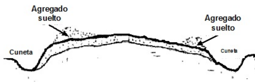
Figura 2.24: Segregación de agregados.
