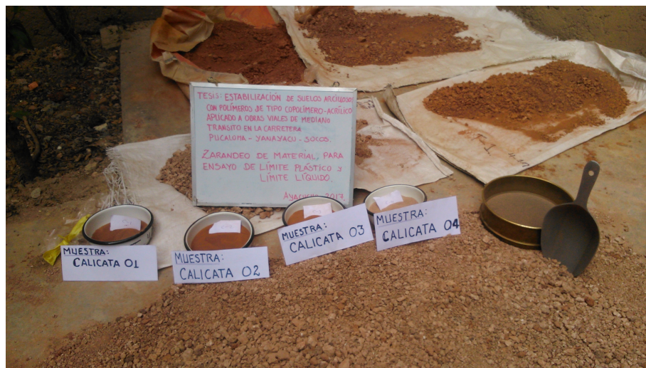
Figura 3.10: Zarandeo de material (Geotecnia & Ingeniería, 2018).
