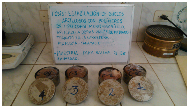
Figura 3.8: Muestras para hallar porcentaje de humedad (Geotecnia & Ingeniería, 2018).
