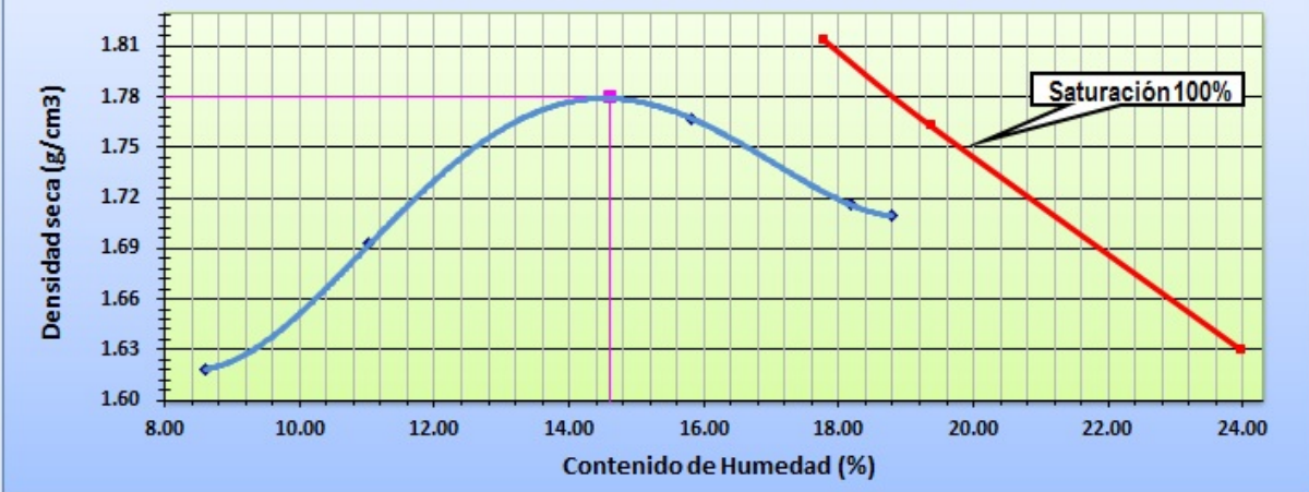
Figura 13.7: Ensayo de compactación - próctor modificado suelo - polímero (Muestra N° 02 polímero 8%).
