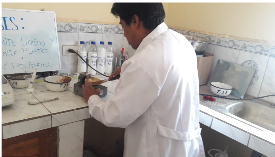
Figura 3.11: Ensayo para Límite Líquido en Copa de Casagrande (Geotecnia & Ingeniería, 2018).
