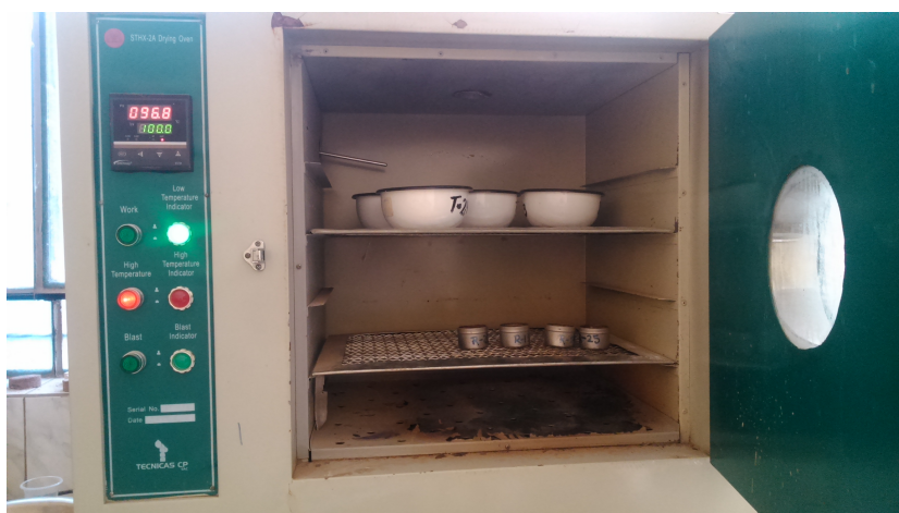
Figura 3.9: Secado de muestras para determinar el Contenido de Humedad.
