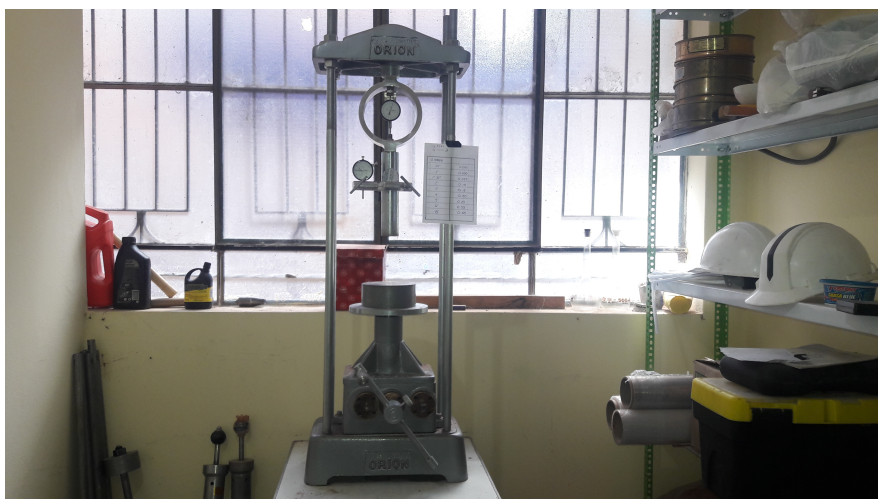
Figura 3.5: Prensa de carga CBR (Geotecnia & Ingeniería, 2018).
