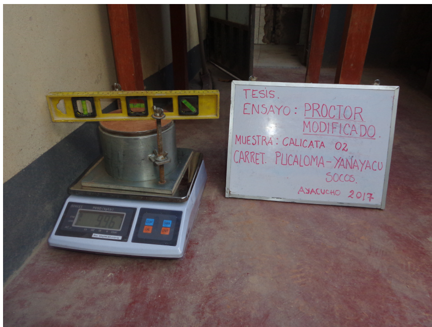
Figura 3.18: Enrasado del molde (Geotecnia & Ingeniería, 2018).
