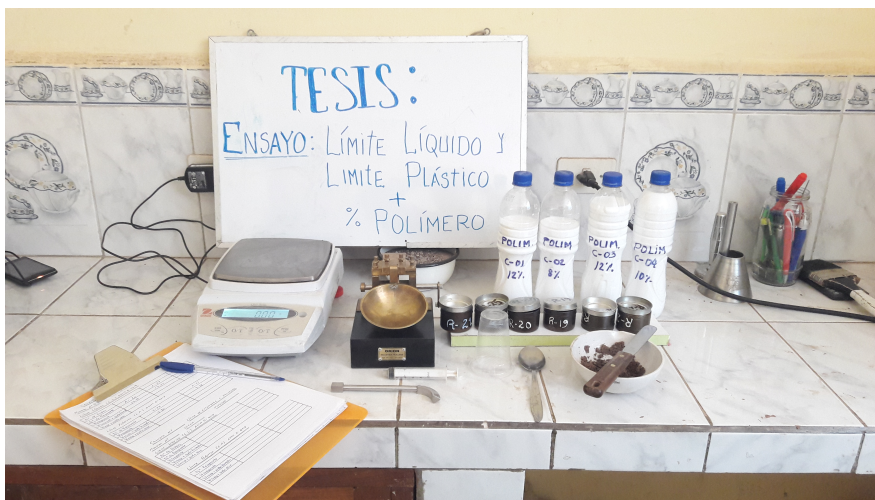
Figura 3.2: Instrumentos para límite Líquido y plástico (Geotecnia & Ingeniería, 2018).
