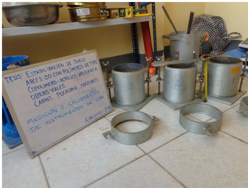
Figura 3.21: Medición y calibración de instrumentos de CBR (Geotecnia & Ingeniería, 2018).
