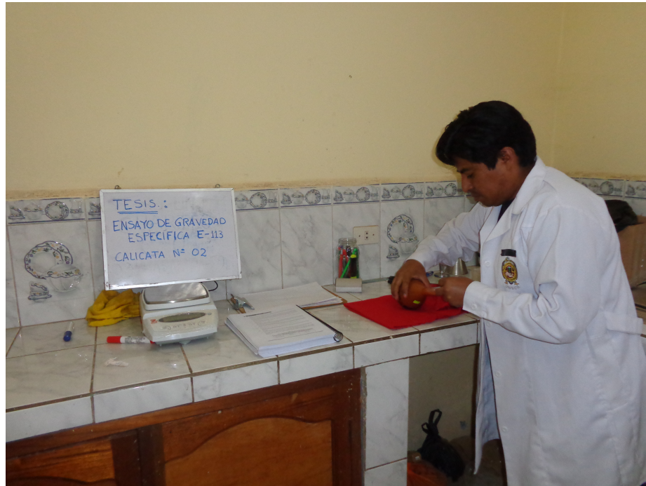
Figura 3.14: Liberación de aire de la muestra (Geotecnia & Ingeniería, 2018).
