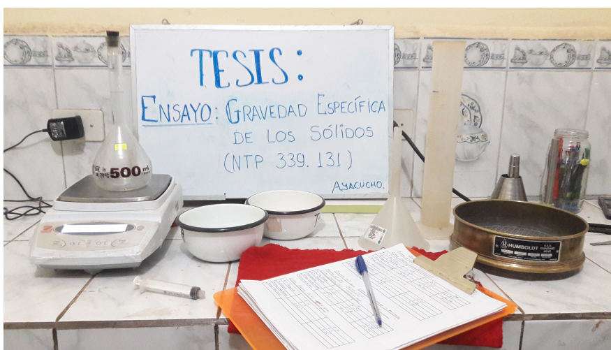
Figura 3.3: Instrumentos para la determinación de Gravedad Específica.
