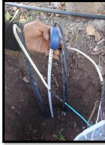
Instalación del Sensor FC – 28 a 30 cm de profundidad
