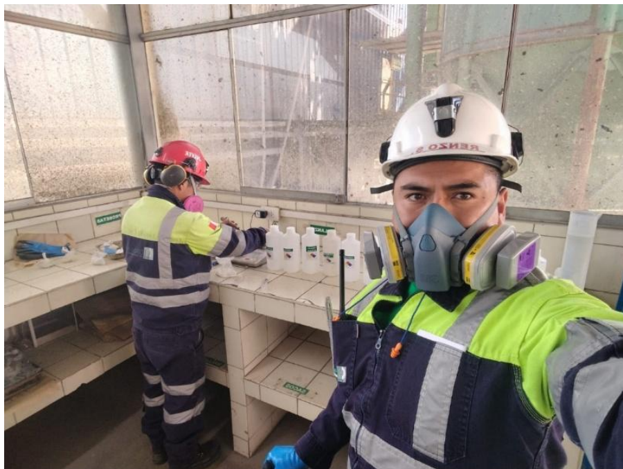
Preparación de reactivos a escala de laboratorio con datos reales del consumo de planta concentradora.
