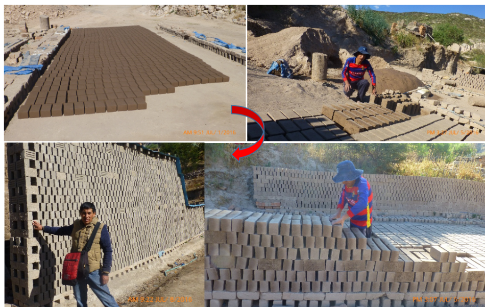
Figura 3.8: Formas de secado de ladrillos artesanales en Ayacucho.
