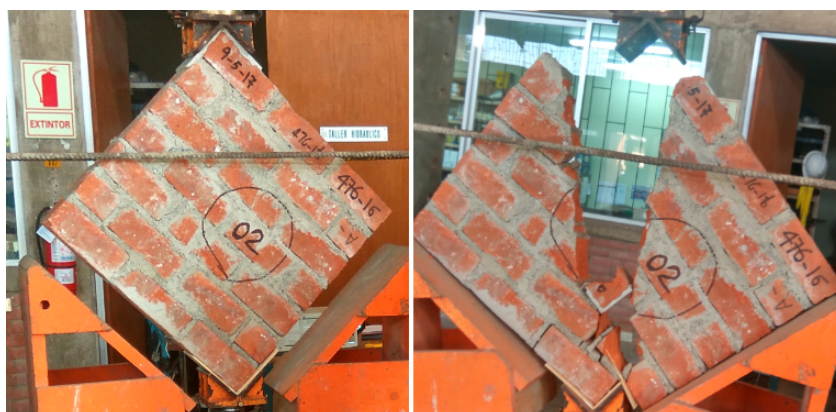
Figura 3.28: Falla típica del murete 02.
