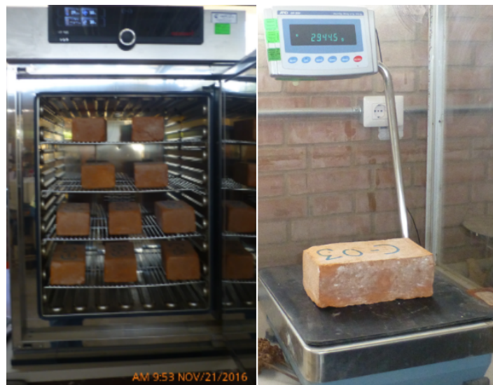
Figura 3.15: Secado en horno eléctrico y pesado de unidades.
