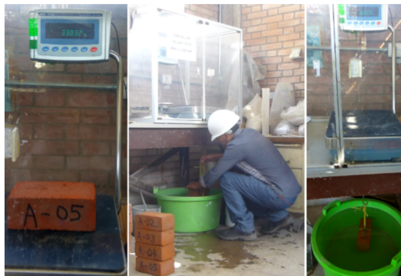
Figura 3.20: Peso saturado en ebullición y peso sumergido.
