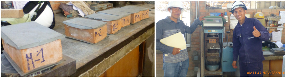
Figura 3.14: Preparación de capping y prensa hidráulica.
