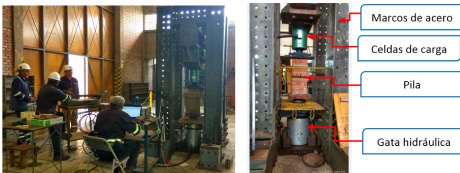
Figura 3.23: Dispositivos de ensayo para pilas de albañilería.
