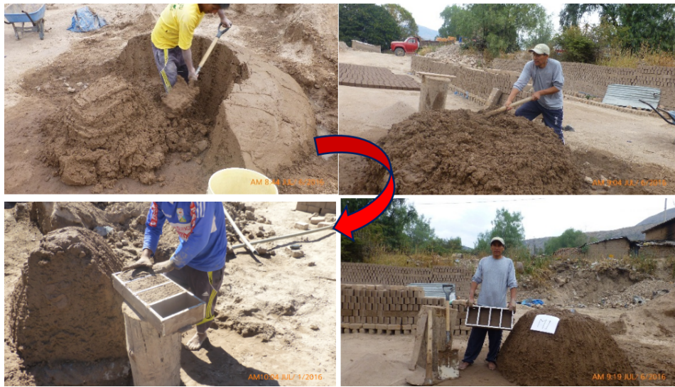
Figura 3.7: Moldeado de ladrillos artesanales.
