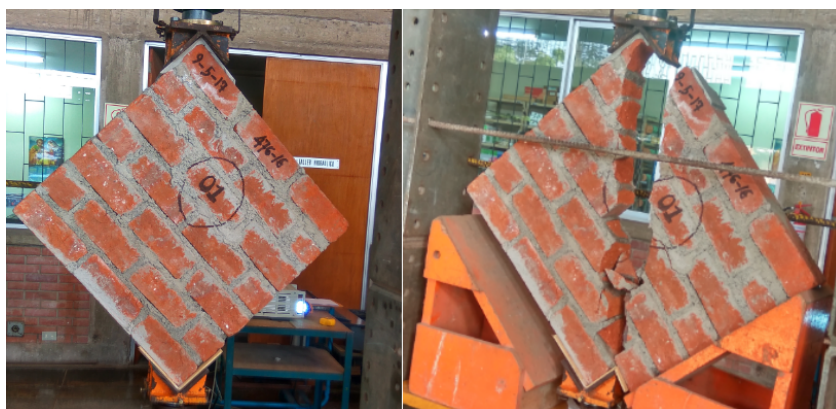
Figura 3.27: Falla típica del murete 01.
