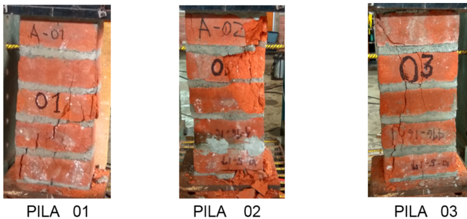
Figura 3.24: Pilas de albañilería ensayadas.
