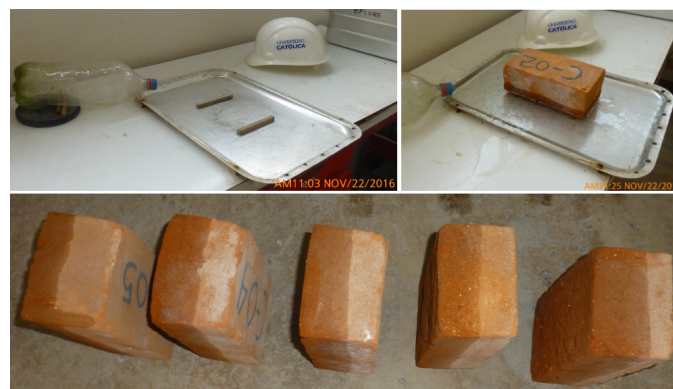
Figura 3.16: Prueba de succión de unidad en 1 minuto.
