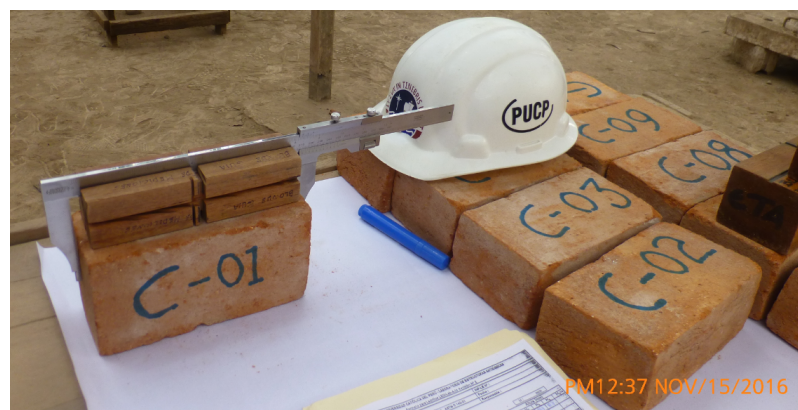
Figura 3.12: Prueba de variación dimensional.
