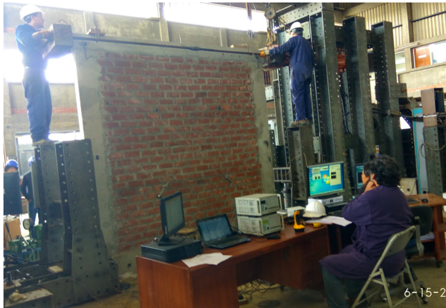
Figura 3.56: Distribución de LVDT y el equipo de monitoreo.
