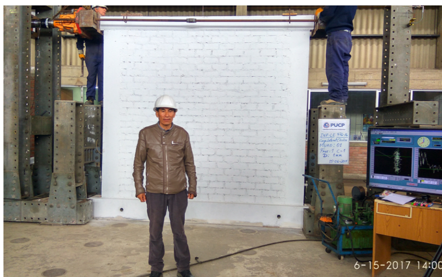
Figura 3.54: Calibración de LVDT con precarga horizontal de 300\text{ kg} .
