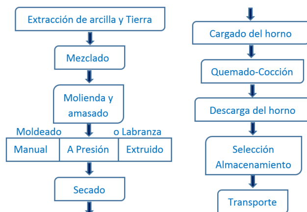
Figura 3.3: Diagrama de flujo de fabricación de ladrillos.
