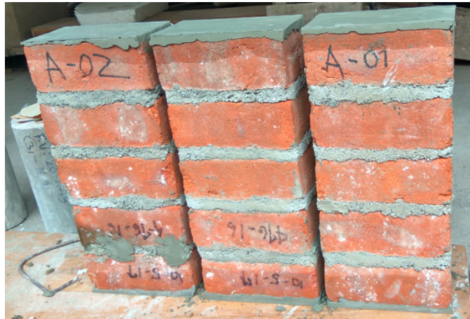
Figura 3.22: Pilas con capping colocado.
