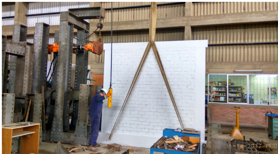
Figura 3.52: Transporte de muro a la sala de ensayo.
