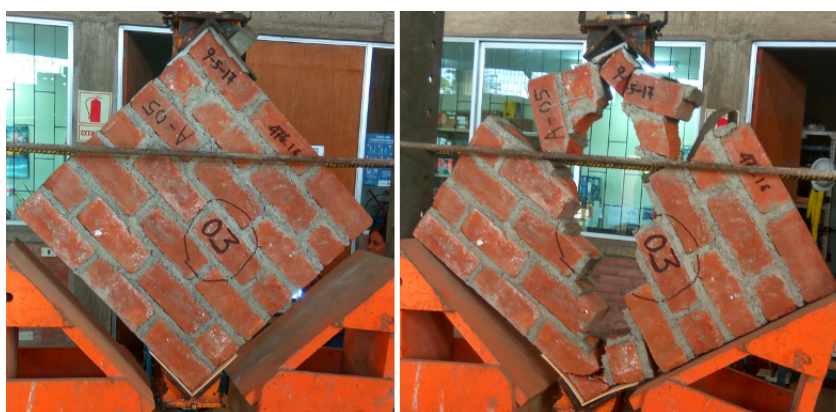
Figura 3.29: Falla escalonada del murete 03.
