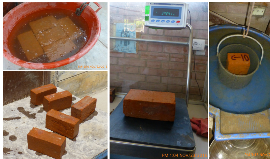
Figura 3.18: Ensayo de absorción, peso de la unidad saturado y sumergido.
