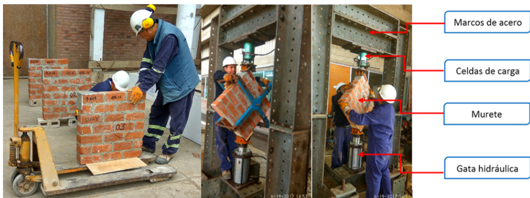
Figura 3.26: Traslado, colocación y ensayo de muretes.
