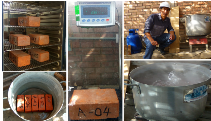
Figura 3.19: Ensayo de absorción máxima saturado en ebullición de 5 horas.
