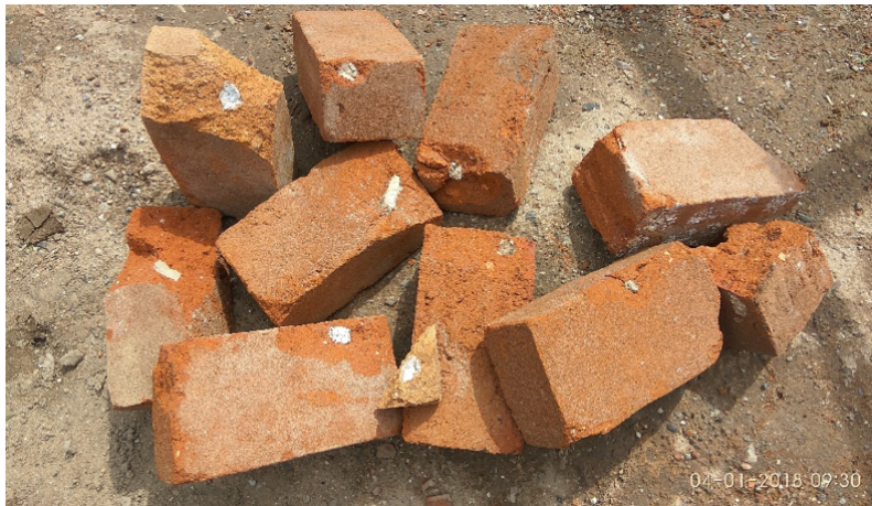
Figura 1.6: Unidades con presencia de caliches después de la cocción.
