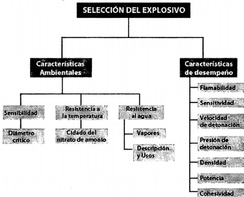
Fig. IV 03 Selección de explosivos según sus características
