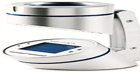
Figura 2: Muestreador de aire usado para control microbiológico de aire.
