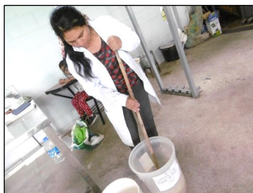
Foto 09. Proceso de curtido y reposo durante 24 horas
