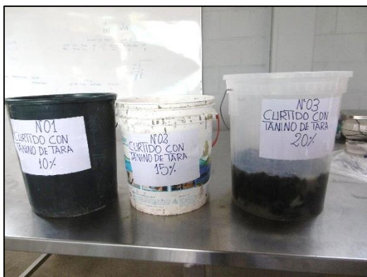
Foto 09. Proceso de curtido y reposo durante 24 horas
