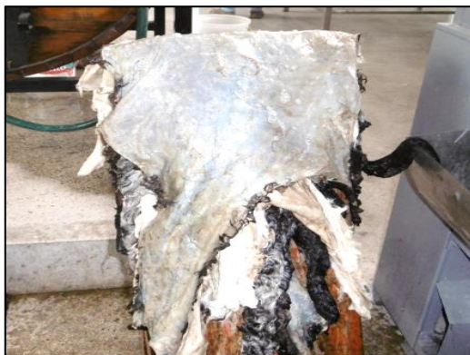
Foto 06. Lavado de las pieles en botal después de descarnado
