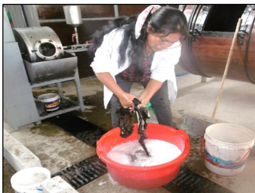
Foto 06. Lavado de las pieles en botal después de descarnado
