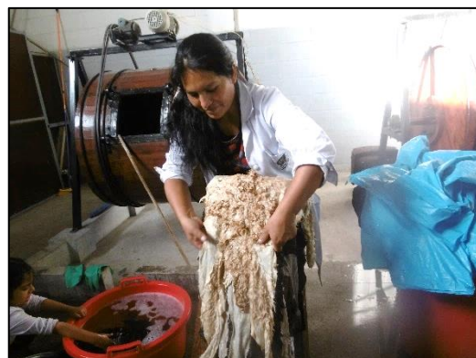
Foto 06. Lavado de las pieles en botal después de descarnado
