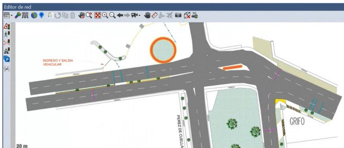
Figura 27: Geometría de la intersección, creación de link y conectores
