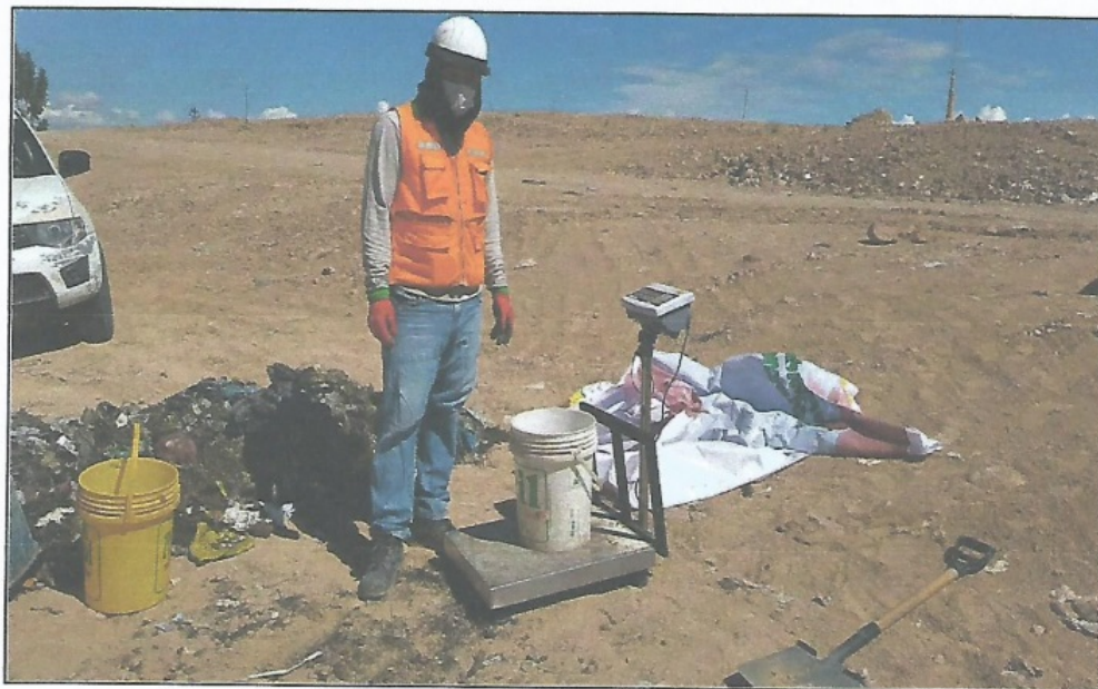
Fotografía N°04. Pesaje de los recipientes para determinar peso de agua.
