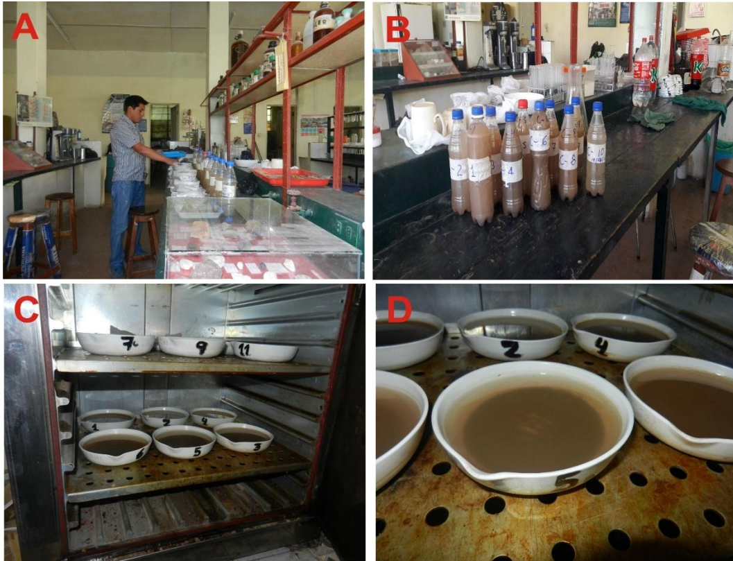
Figura 69: Análisis de las muestras del gasto sólido en suspensión en laboratorio.
