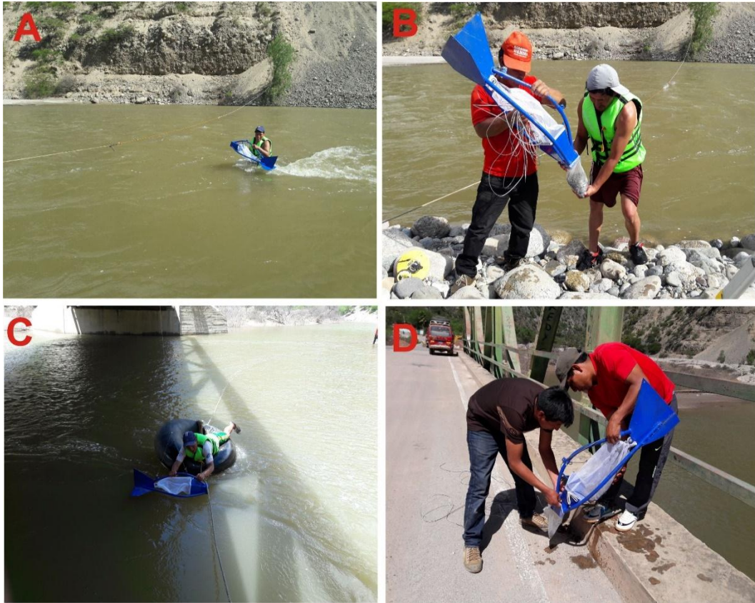
Figura 67: Monitoreo del gasto sólido de fondo con Helley – Smith.
