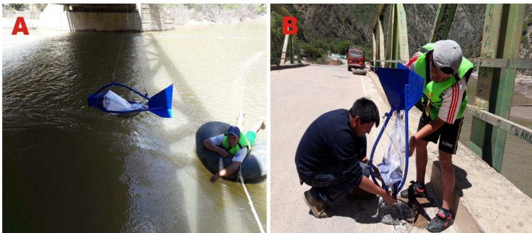
Figura 37: A) Ascenso del muestreador HELLEY SMITH, tras la captura de sedimentos, B) Obtención del gasto sólido de fondo los cuales son vertidos a una bolsa para ser pesado en laboratorio.
