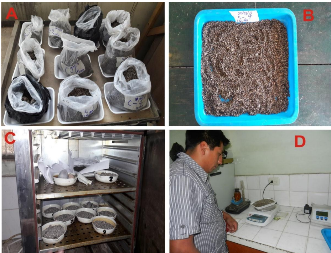
Figura 68: Análisis de muestras en laboratorio, secado al ambiente y a estufa y pesado.
