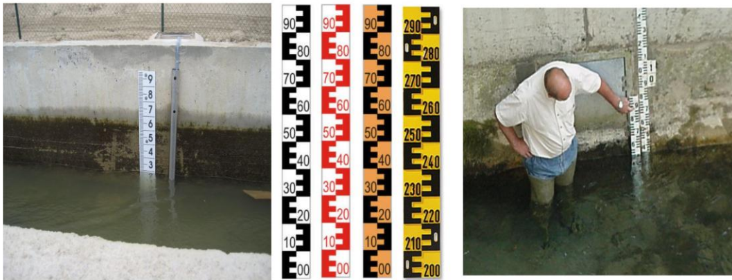
Figura 11: Escala limnimétrica es una regla graduada que permite medir las fluctuaciones del nivel del agua.
