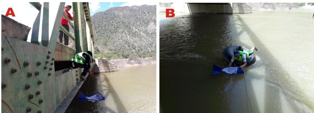
Figura 36: Procedimientos de toma de Muestra, A) suspensión mediante un cable al Muestreador para la captura de sedimento, B) captura de sedimentos del gasto sólido de fondo apoyado con un flotador.
