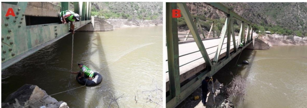
Figura 32: Batimetría de la sección de aforo con equipos topográficos
