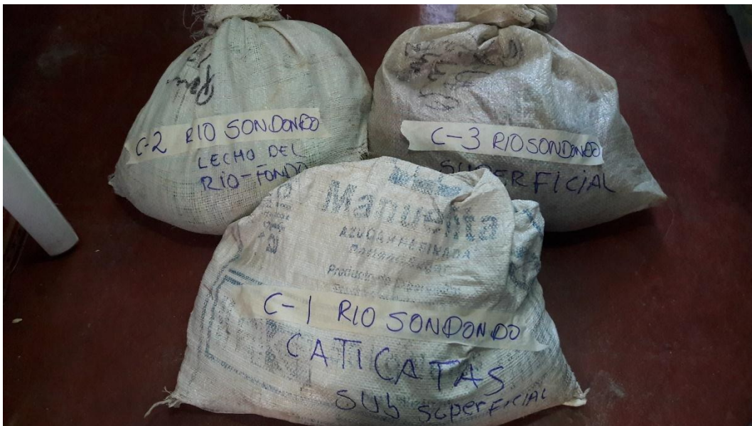
Figura 64: Muestras de agregados recogidas para el ensayo de granulometría en laboratorio.
