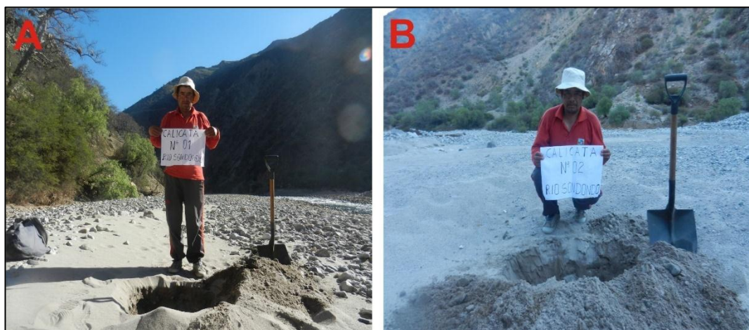
Figura 61: Excavación de calicatas para caracterizar la granulometría del material sub superficial en época seca.
