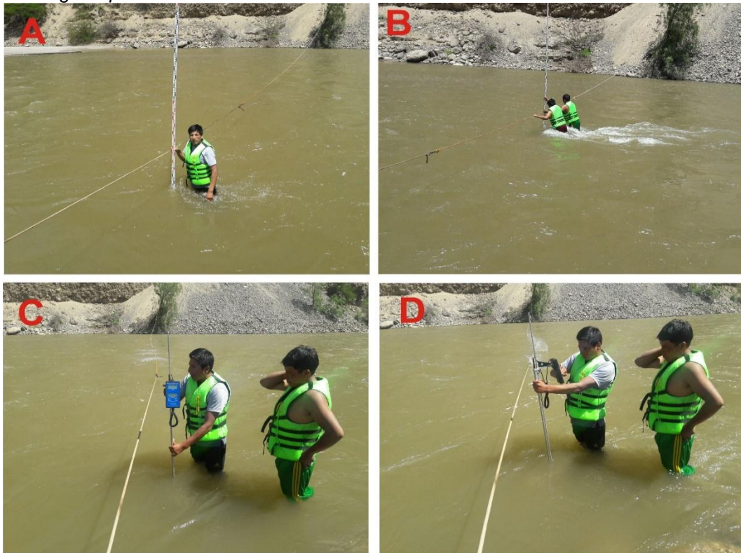
Figura 66: (a, b) Determinación de la sección transversal del curso, (c, d) aforo con correntómetro.
