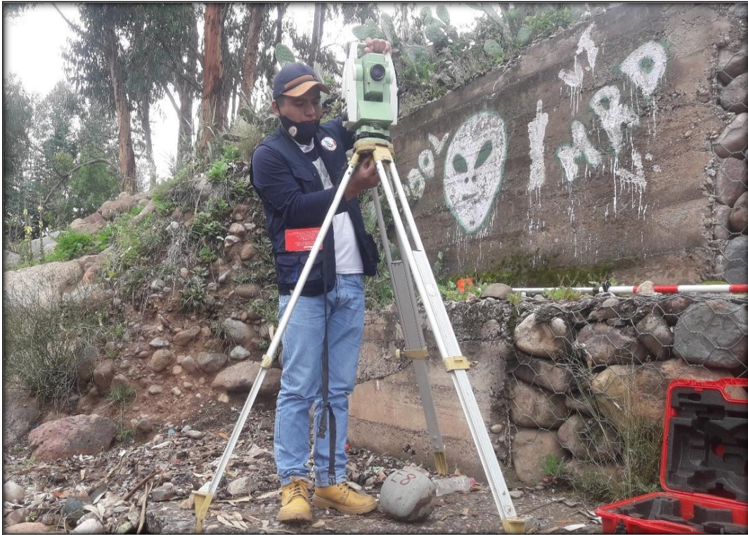
Figura C.3. Estacionamiento de la estación total para el levantamiento topográfico.
