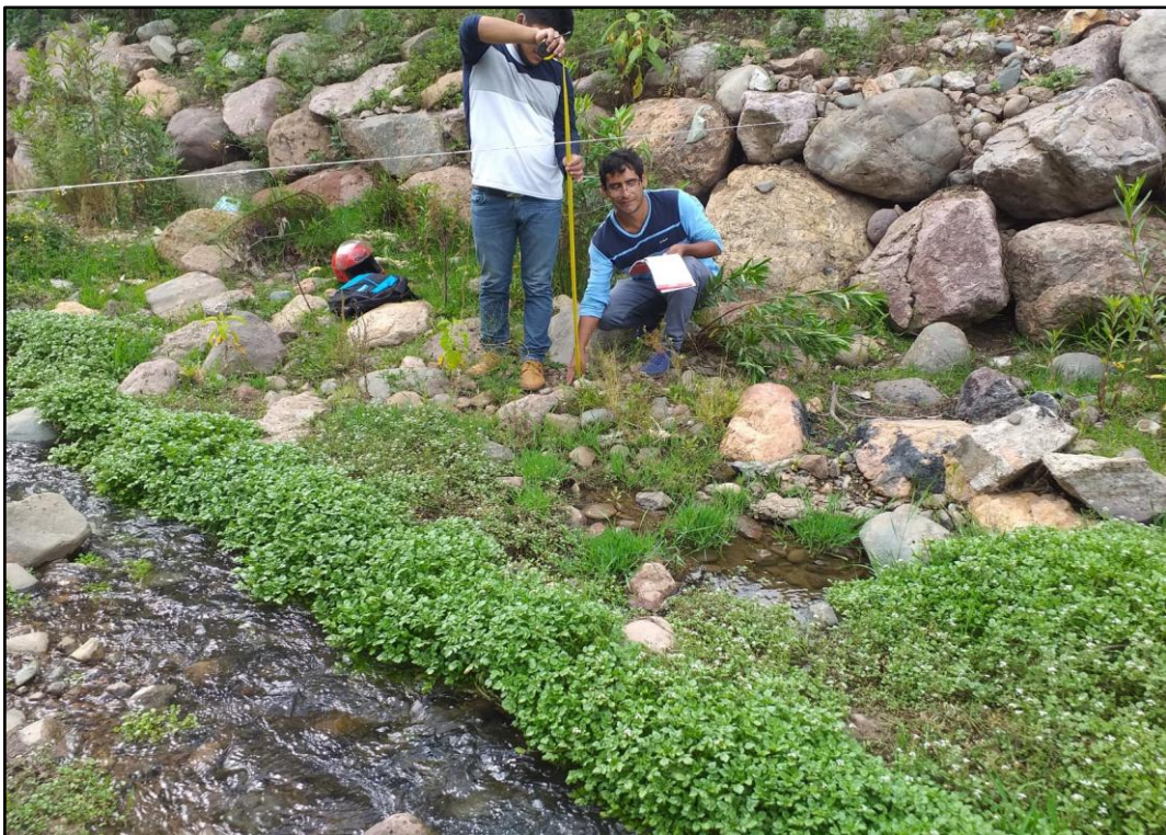
Figura C.6. Medida de la sección y pendiente para la huella máxima.
