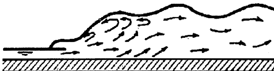
Figura N° 10.06: F_1 = 4.5 a 9 , Resalto fuerte
