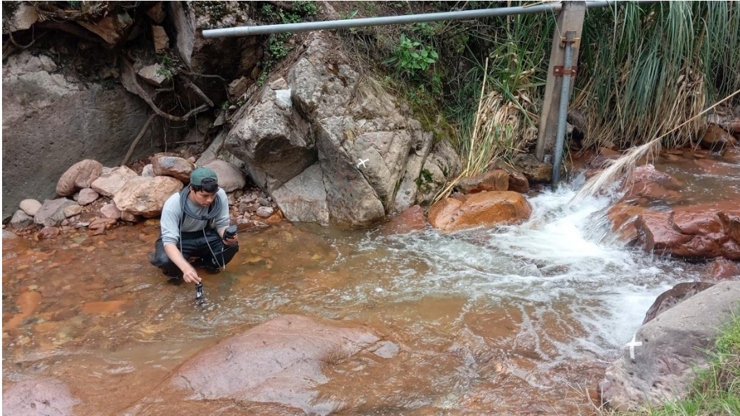
Fotografía n° 13: Medición de la conductividad eléctrica una vez vertido la solución de 20 litros.
