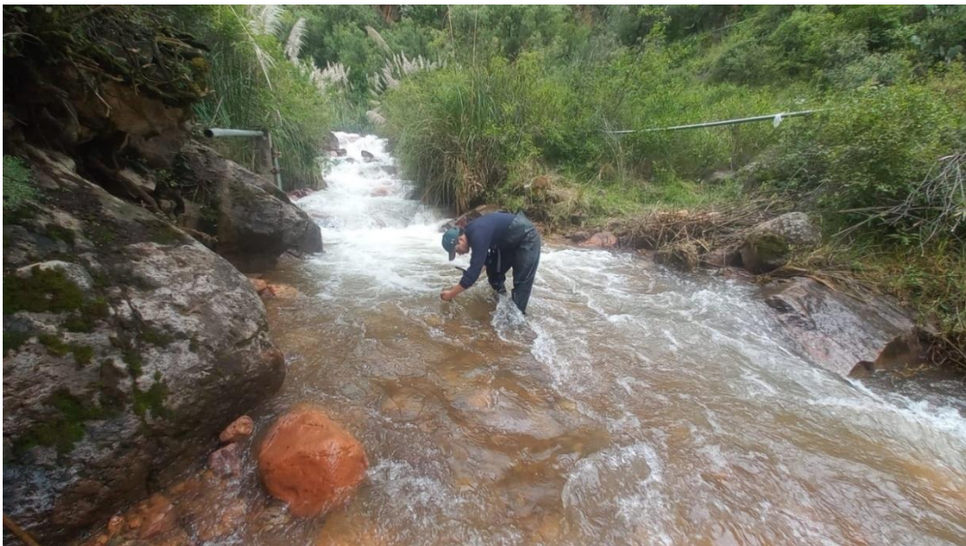
Fotografía n° 12: Medición de la conductividad eléctrica una vez vertido la solución de 20 litros.
