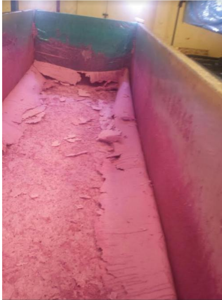
Falta de agente surfactante (Silicona)
