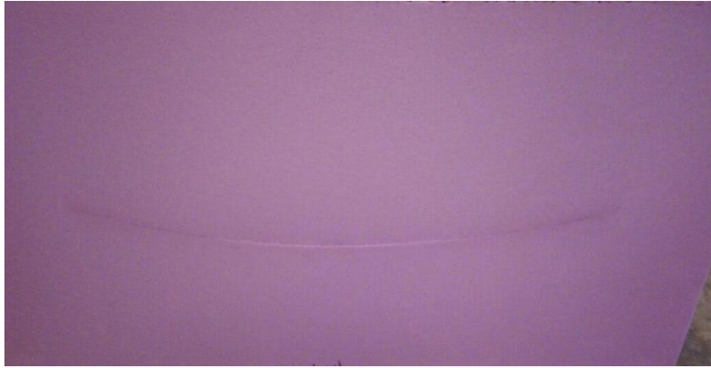
Falta de catalizador de estaño
