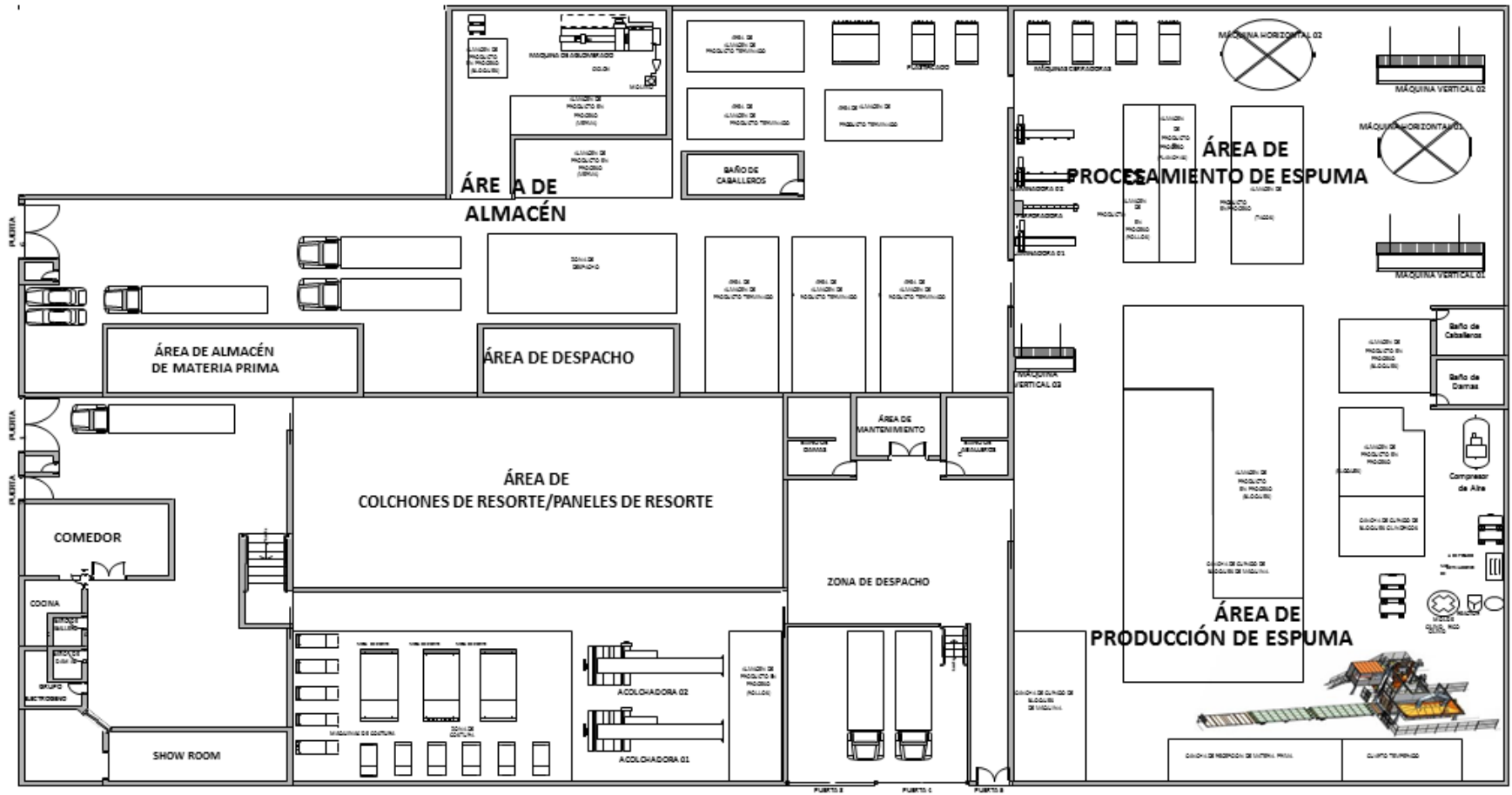
Figura 3.13. Distribución De La Planta
