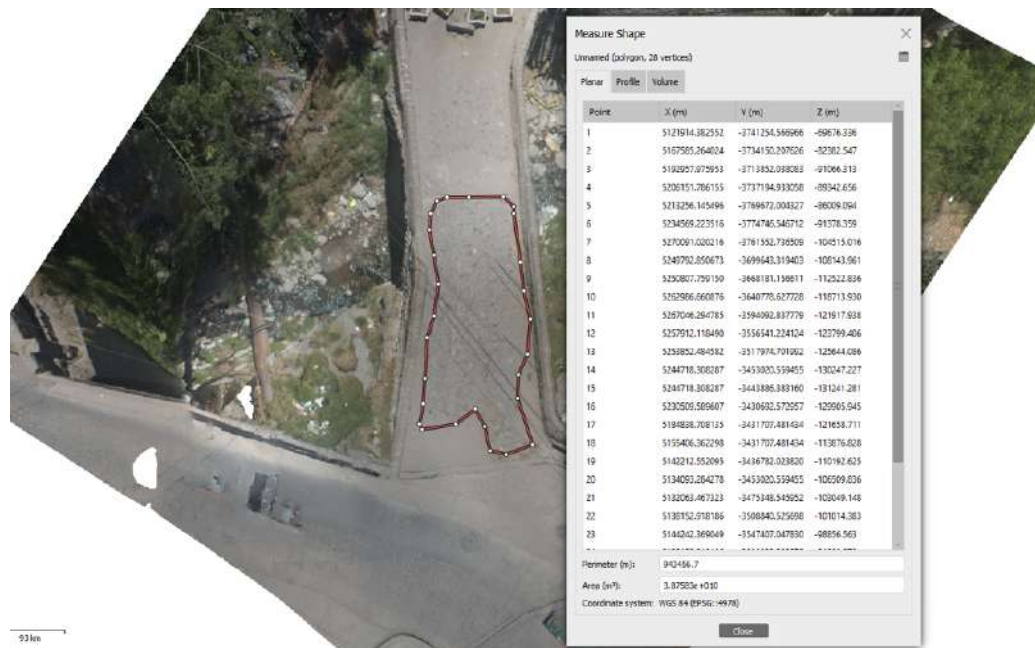
Figura 4.14: Calculo de área y volumen de fallas del puente San Sebastián.
