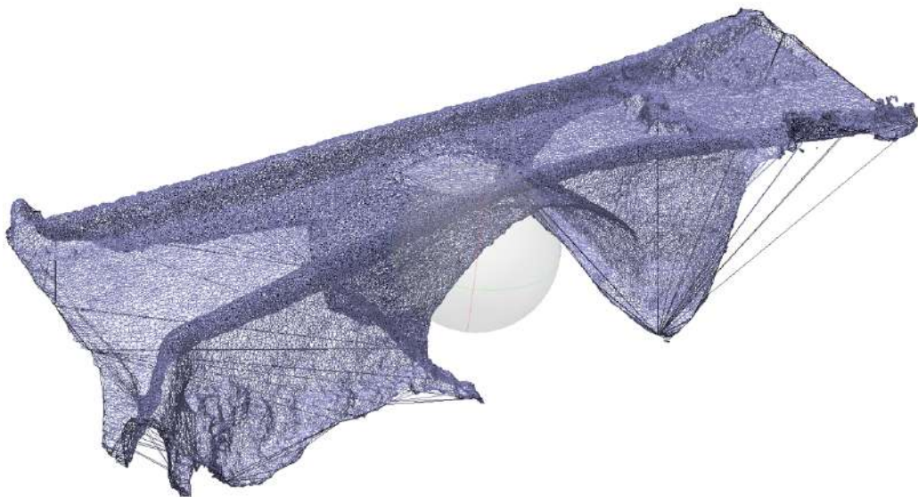
Figura 4.7: Malla de triangulos con cierre de huecos.
