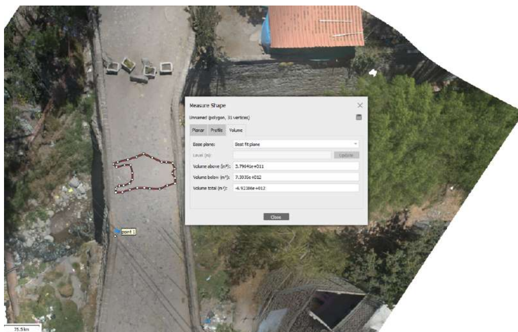
Figura 4.19: Calculo de área y volumen de fallas del puente San Sebastian.
