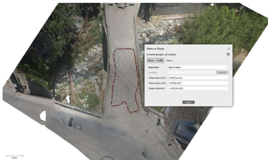
Figura 4.15: Calculo de área y volumen de fallas del puente San Sebastián.
