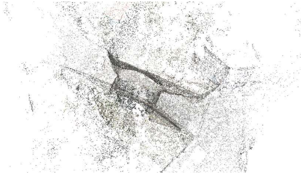
Figura 4.4: Nube de puntos esparcida.
