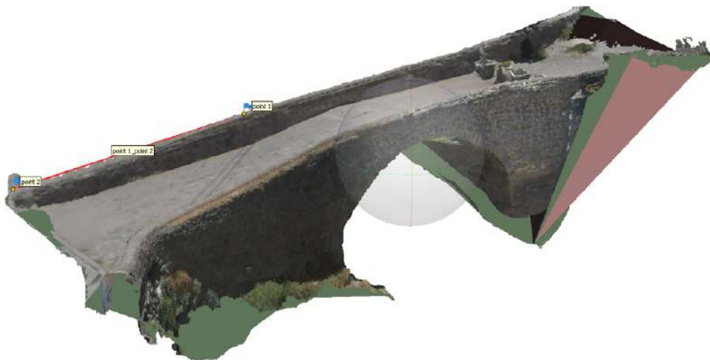
Figura 4.10: Modelo 3D generado del puente San Sebastian.
