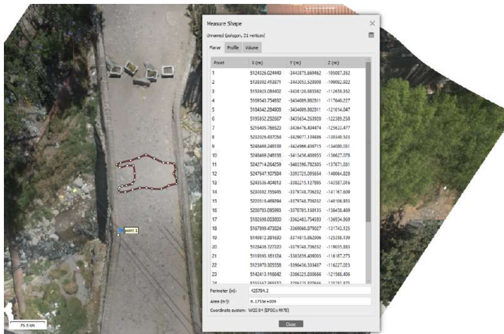
Figura 4.18: Calculo de área y volumen de fallas del puente San Sebastián.
