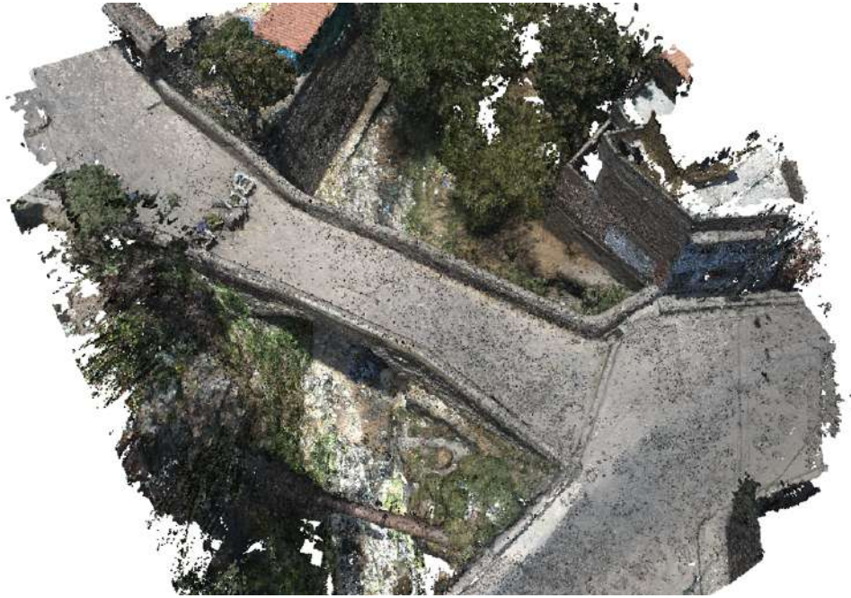
Figura 4.5: Nube de puntos densa.
