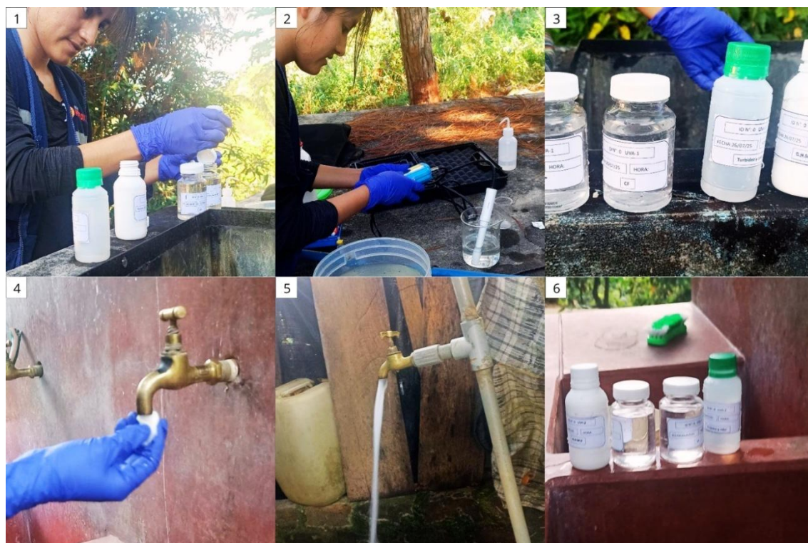
(1) Recolección de muestras de agua en reservorio de Monterrico Alta (2) Medición de parámetros fisicoquímicos del agua, ex situ (3) Frascos etiquetados con muestras de agua tomadas de reservorio (4) Desinfección del grifo doméstico (5) Purga de agua abriendo el grifo con el caudal al máximo (6) Frascos etiquetados con muestras de agua tomadas de grifos domésticos.
