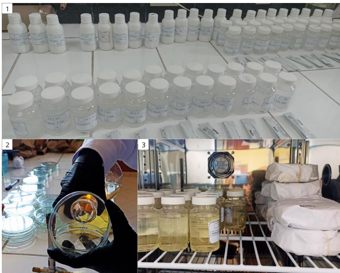
(1) Procesamiento de muestras de agua para detección de coliformes utilizando Colilert-18 (2) Inoculación en placa para bacterias heterotróficas (3) Incubación de las muestras previamente procesadas.
