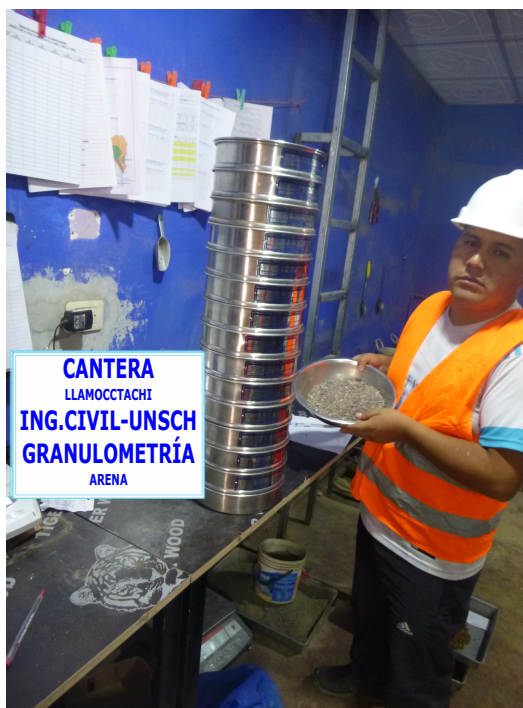
VISTA N°. – 02 – 01 TAMIZADO DE ARENA
