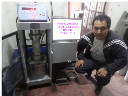
VISTA N°. – 02 – 01 COLOCACIÓN DE PROBETA 4"x8" PARA LA PRUEBA DE COMPRESIÓN
