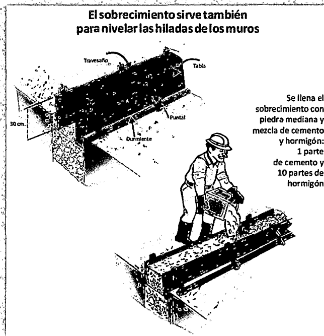
Figura N° 25: Sobrecimiento con concreto simple.
