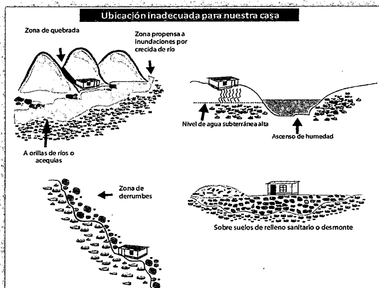
Figura N° 06: Ubicaciones inadecuadas para viviendas.
