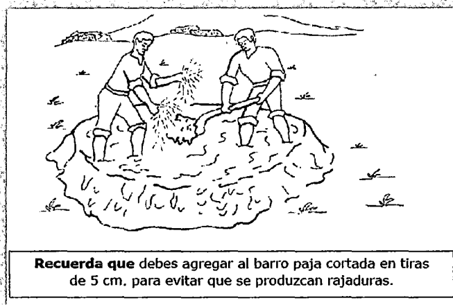
Figura N° 12: Preparado del barro agregando paja.
