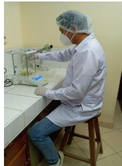
Pesado de 10g de la muestra molida con balanza analítica
