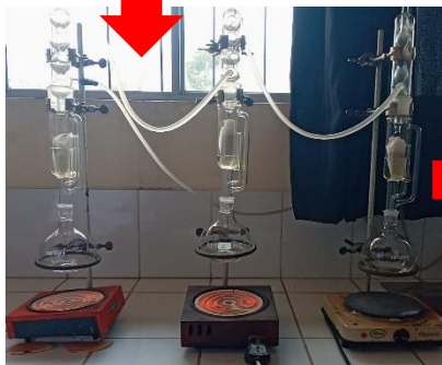
Revisar las tres repeticiones, activar el sistema de refrigeración, encender las hornillas y estar vigilante al cumplimiento de los 7 ciclos consecutivos
