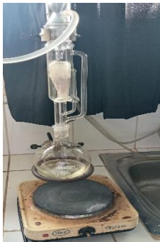
Armado del equipo de Soxhlet y colocación del cartucho con la muestra y el N-hexano
