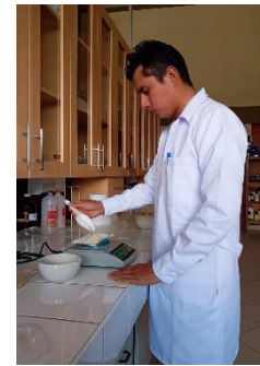
Pesado de 30g de la muestra con balanza simple
