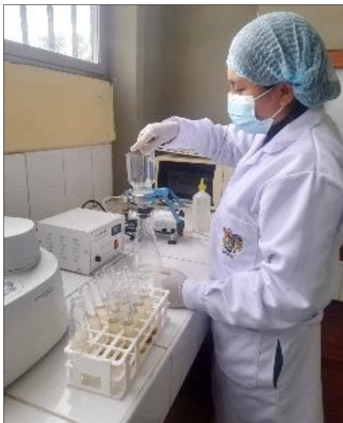
Anexo 10. Filtración de los tratamientos en el equipo de succión con bomba al vacío. Ayacucho – 2023.
